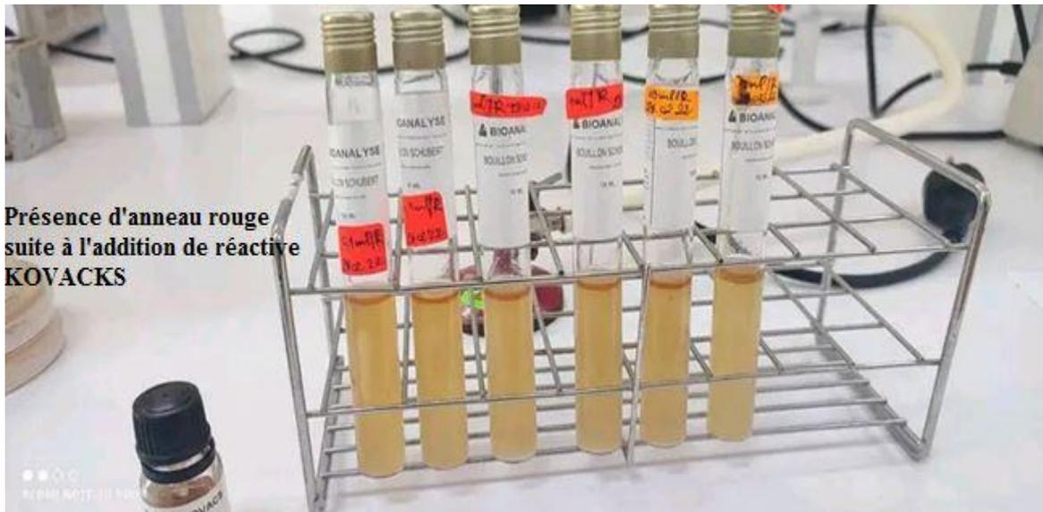
**Figure 18 :** Résultats de la recherche de dénombrement des coliformes fécaux dans le milieu Schubert. (Photo prise par Hebbache.I)
