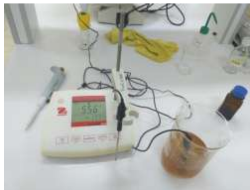
Fig. 17 : Mesure et ajustement du pH d'un milieu de culture.
