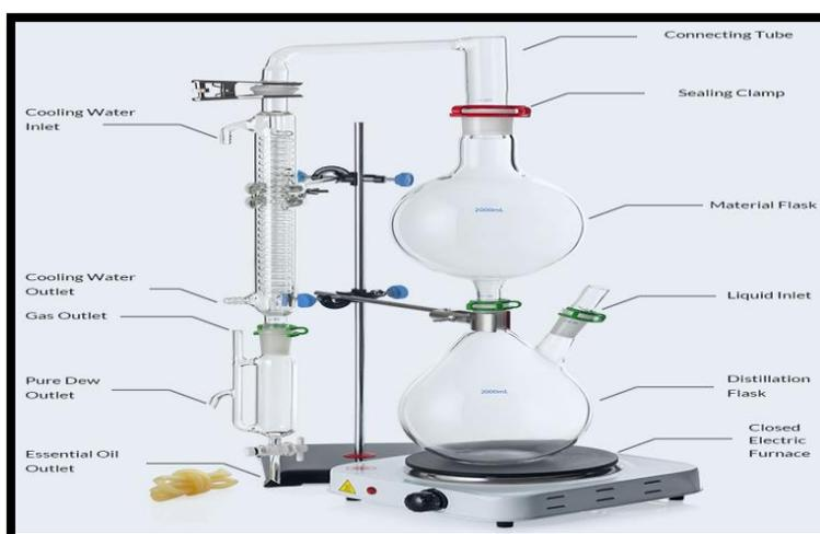
**Figure 6:** Un hydrodistillateur assistée par entrainement à la vapeur d'eau.
