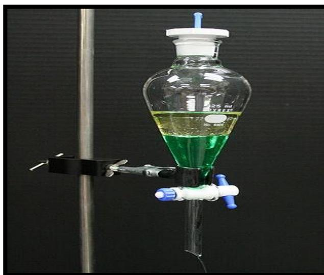
**Figure 9:** Une ampoule à décanter démontrant la séparation de l'huile et de l'eau (photo original).
