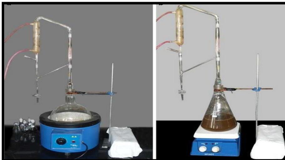
**Figure 5:** Un hydrodistillateur type Clevenger (photo original).
