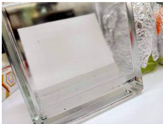
Figure 12 : Plaque CCM dans une cuve à chromatographie
