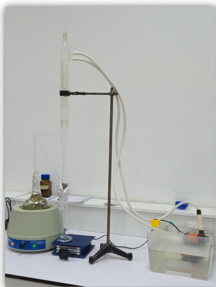
**Figure 12: Montage d'hydrodistillateur de type clevenger (Originale, 2022).**
