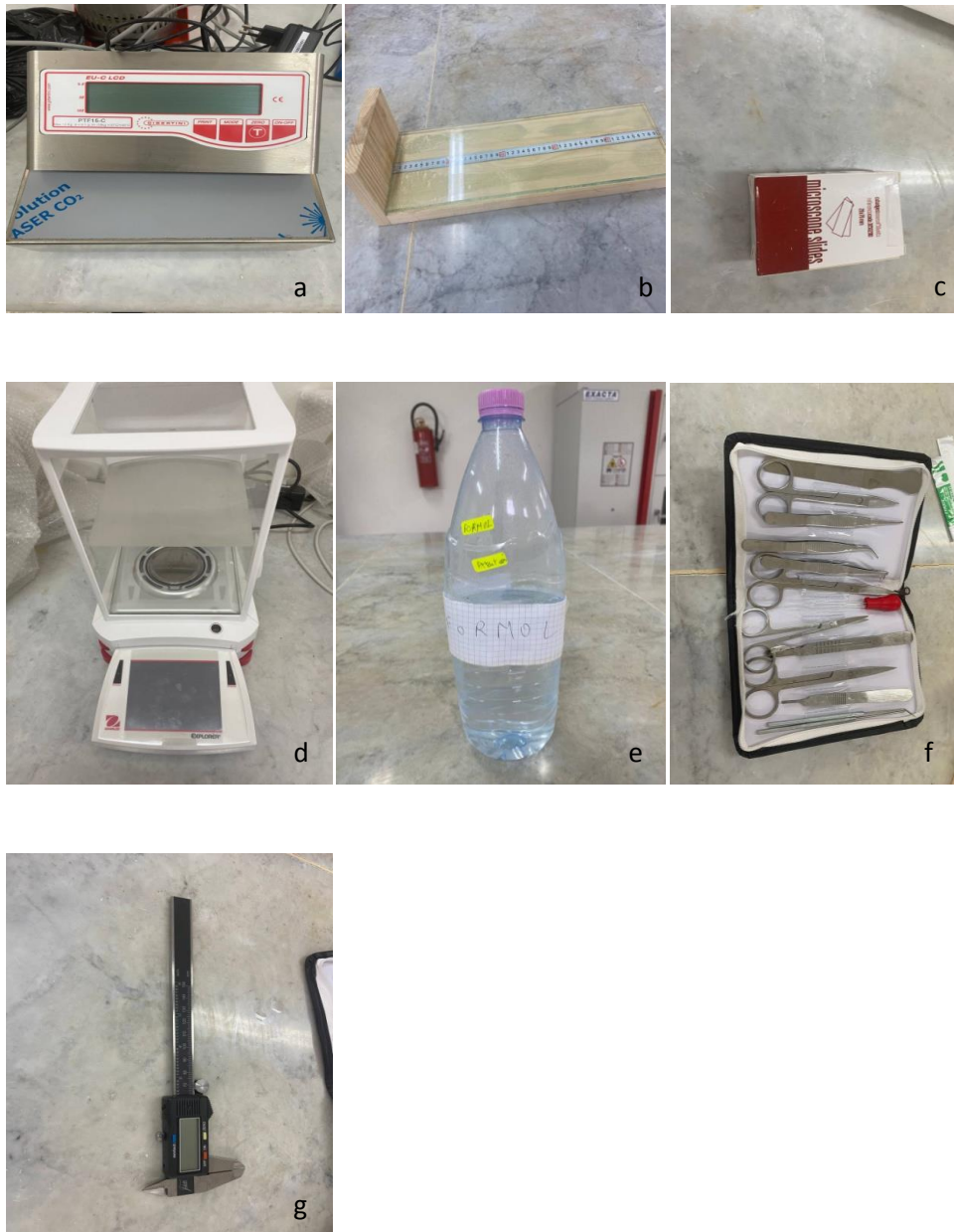
Figure 7 : Matériel utilisé au laboratoire (a : balance électronique, b : ichtyo mètre , c : Lames de microscope, d : balance électronique , e : formol, f : trousse de dissection , g : pied à coulisse) (Photos originales).
