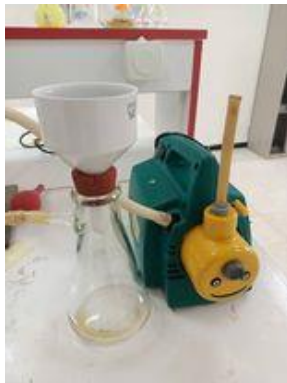
Figure II.8 : Filtration et lavage de la zéolithe 13X
