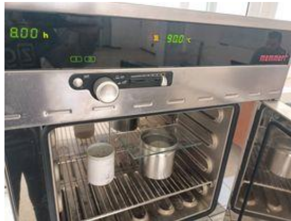
Figure II.7 : Cristallisation des zéolithes 13X.
