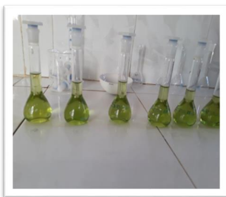
Photo 26 : Dosage de l'ammonium
