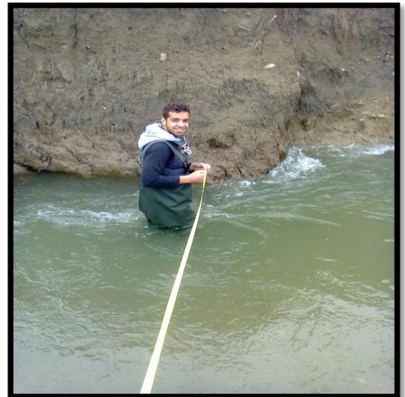
Figure 31 : mesure de largeur
