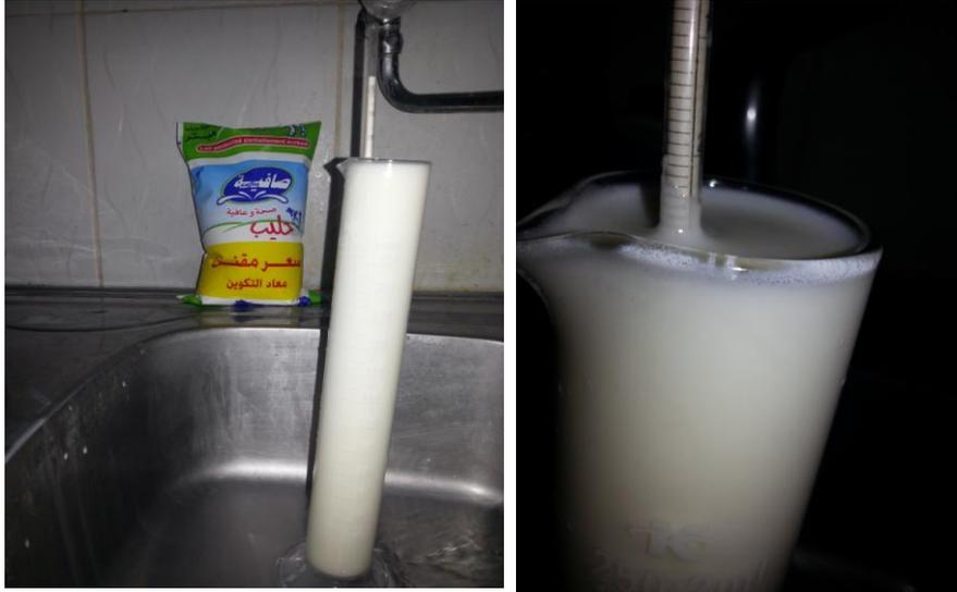
**Figure 5 : Mesure de la densité par lactodensimètre**
