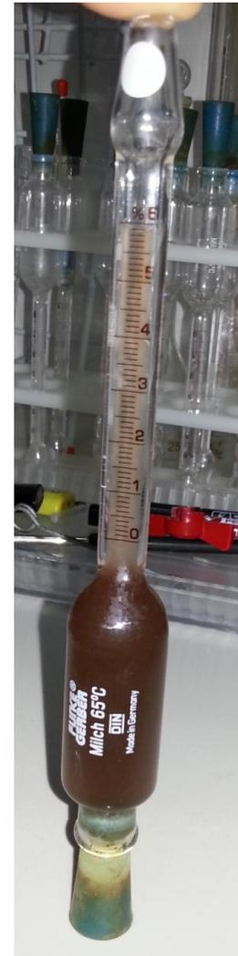
**Figure 6 : Butyromètre**
