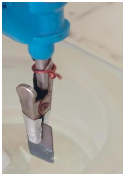
Figure III.7: Électrode de travail en acier.
