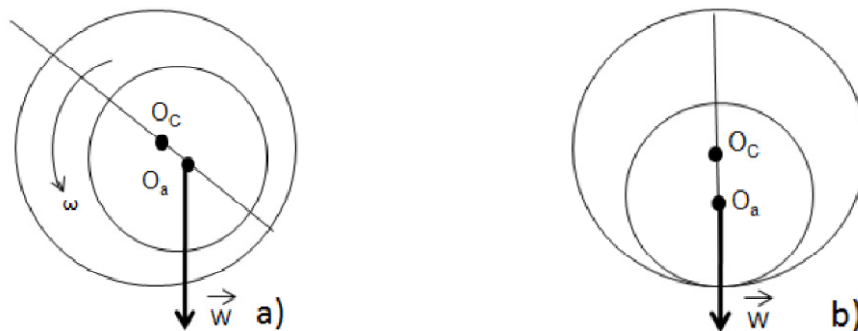
Figure III -12 : Palier fluide hydrodynamique en mouvement (a) et au repos (b)
