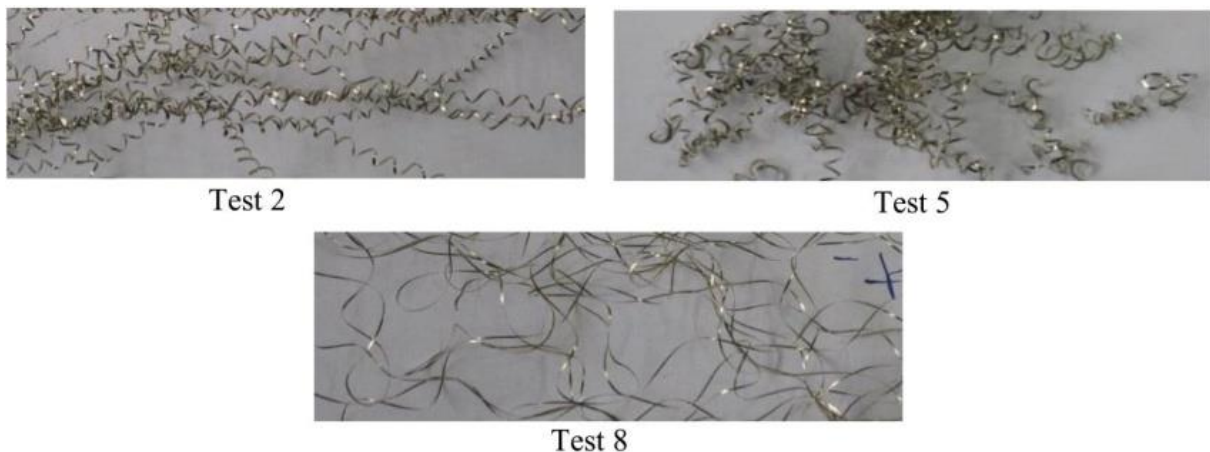
Figure I.23 Morphologie des copeaux produits par les essais 2, 5 et 8.
