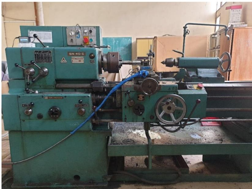
**Figure II.1** Tour à charioter et à fileter modèle SN40
