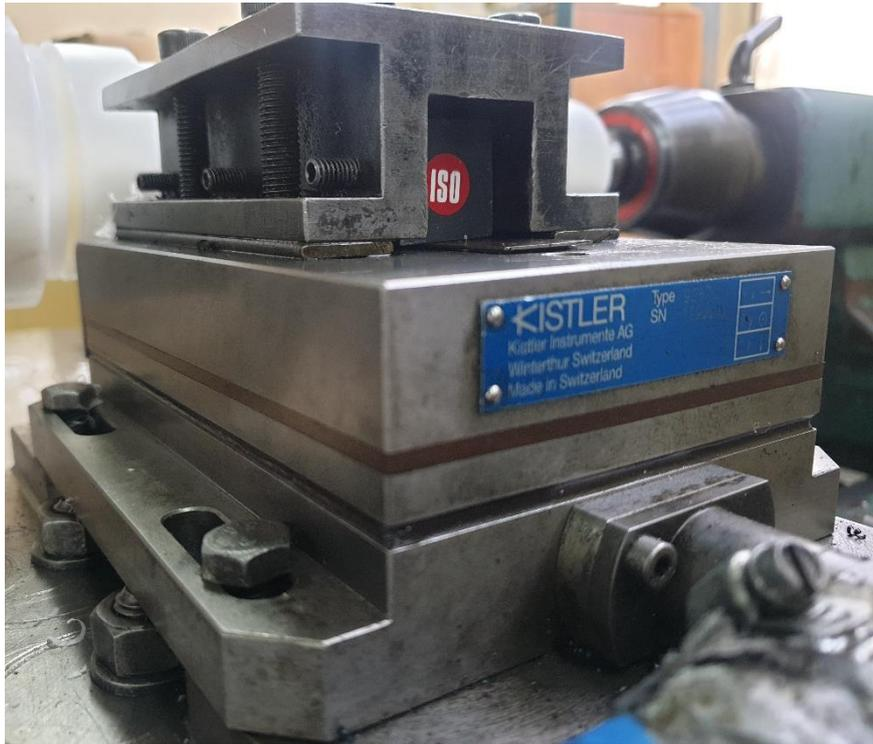
**Figure II.7** Dynamomètre (KISTLER9257 B)
