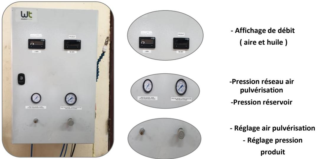
Figure II.13 MQL contrôle
