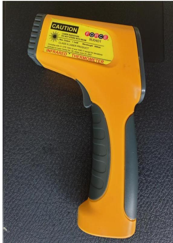
**Figure II.11** Pyromètre à infrarouge.
