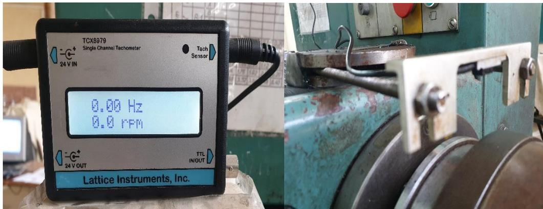
**Figure II.3** Capteur de vitesse
