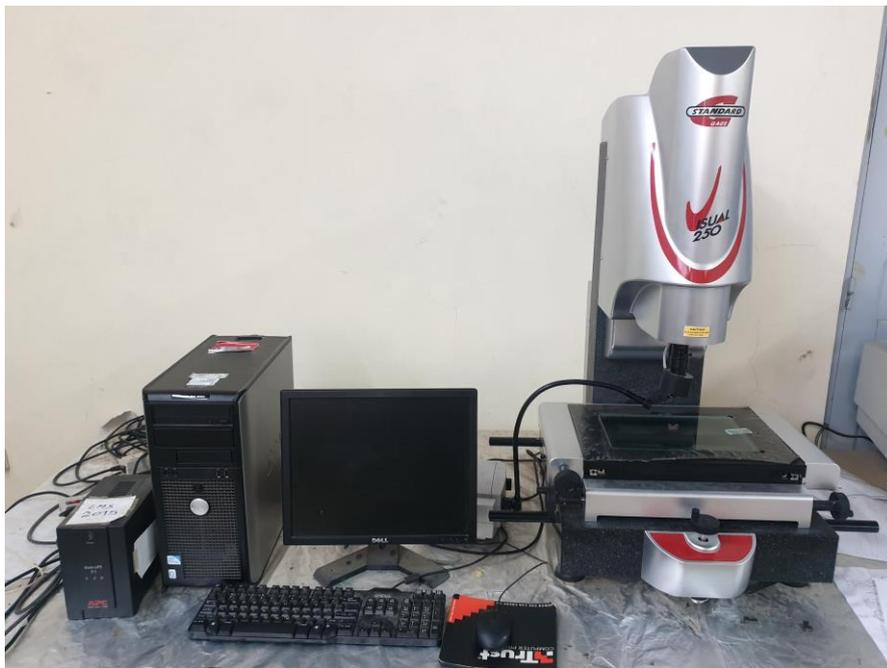
**Figure II.10** Microscope pour la mesure de l'usure Vb (Visuel Gage 250)
