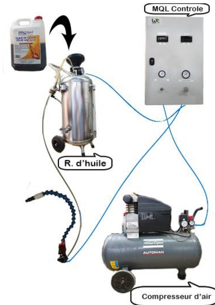
Figure II.12 Montage de système MQL
