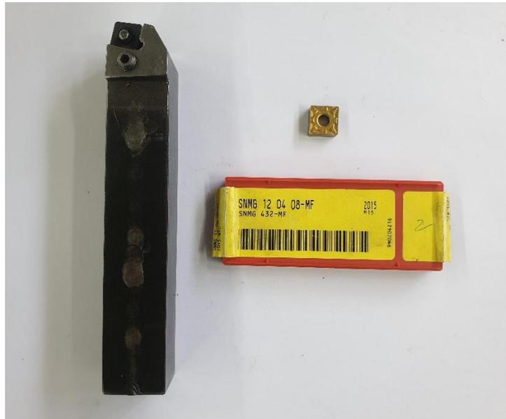
**Figure II.5** Plaquette et porte plaquette utilisés
