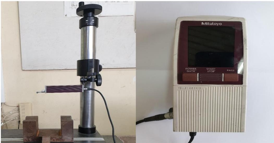
**Figure II.6** Rugosimètre 2D (Surftest SJ-210)
