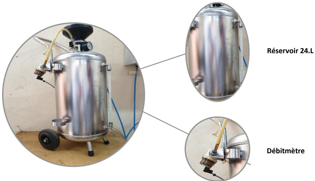
Figure II.14 Réservoir d'huile
