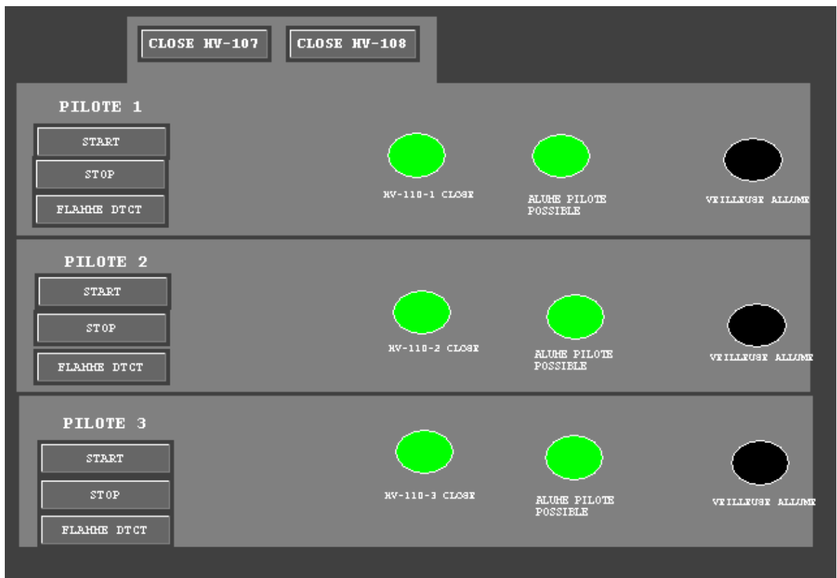
Figure IV. 19. Vue des vannes pilotes
