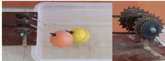
**Figure III.3 :** Conversion unidirectionnel du mouvement
