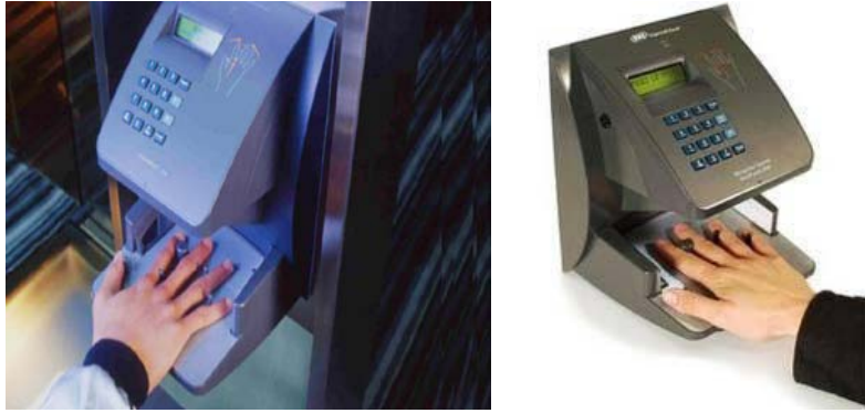
Figure 1.3 : Le capteur utilisé pour la géométrie de la main [14].
