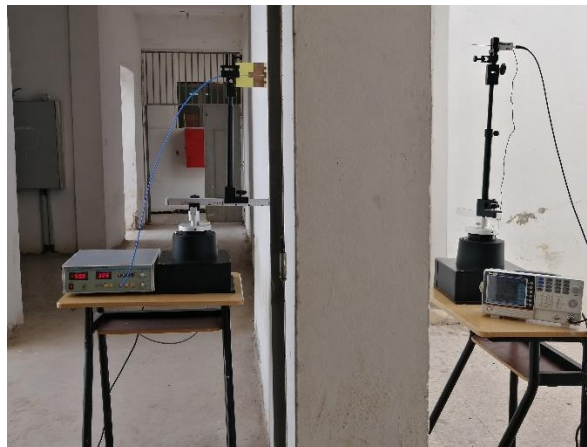
Figure III.15 : mur de test de pénétration.
