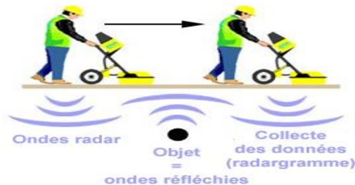
Figure II .4. Technique de sondage par géo radar
