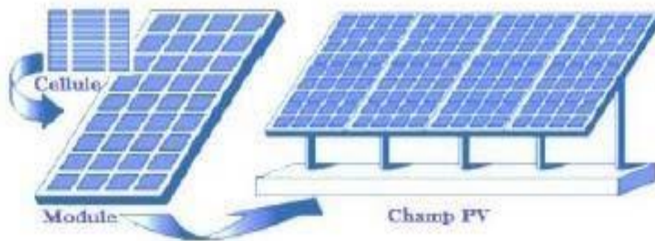
Figure 1.2 Composants d'un GPV
