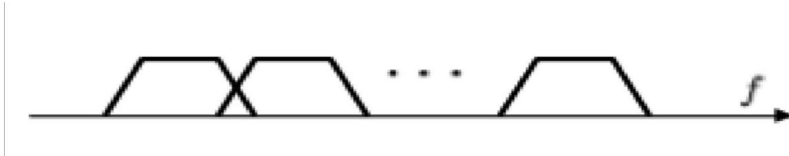
**FIGURE II.19 : Répartition en fréquence de la SMT avec chevauchement [13].**
