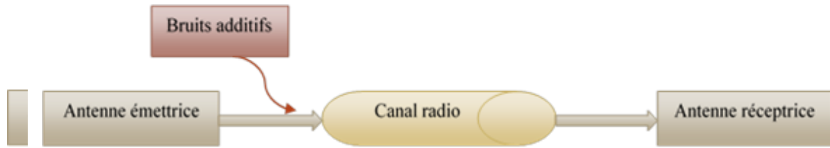
Figure I.2 : Schéma équivalent de canal radio-mobile
