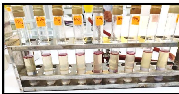
Figure 34: Test confirmatif à 44°C confirme la présence d' E. coli (Prise par Boutebba, 2022).
