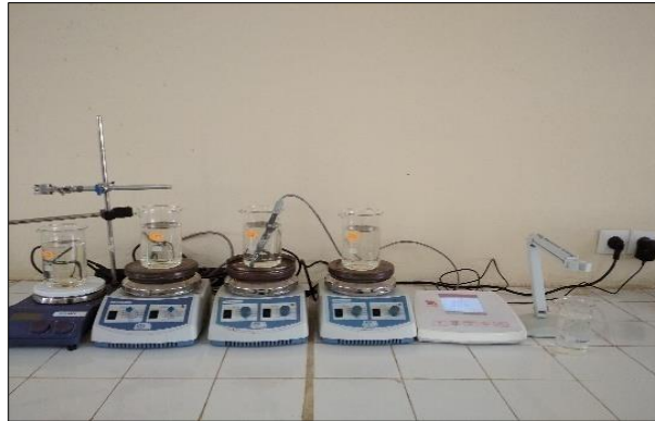
Figure IV.16 : Mesure de conductivité dans la phase coagulation-floculation
