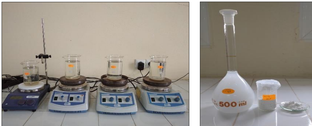
Figure IV.13 : phase de floculation à gauche solution de la flocculant \text{CaCO}_3 à droite
