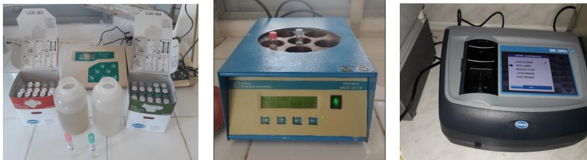
Figure IV.6: l'eau brute et l'eau épurée à gauche au milieu Réacteur utilisée pour la mesure de DCO à droite Spectrophotomètre
