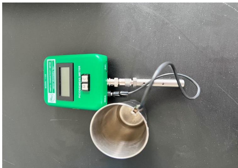
Figure III.10 : Appareil de mesure de conductivité électrique.
