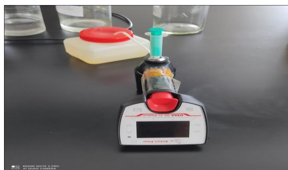
Figure III.6 : Densimètre automatique des produits pétroliers liquides.
