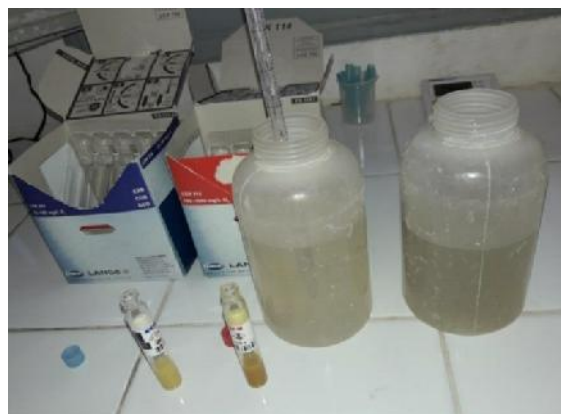
Figure 26: Photo montrant la manipulation pour la détermination d' \text{PO}_4^{3-}
