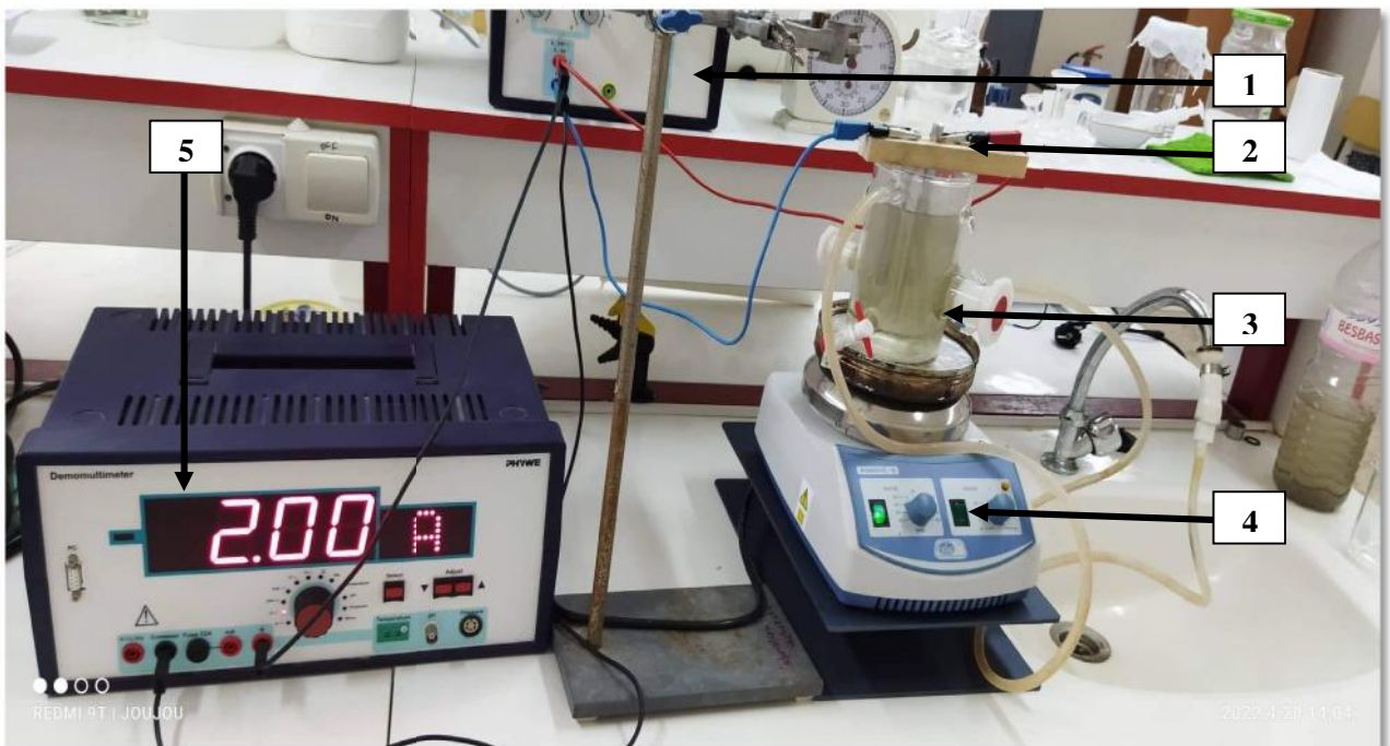
Figure 27 : Le dispositif expérimental d'électrocoagulation
