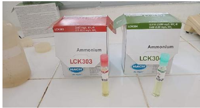
Figure 25: Photo représentant la manipulation pour la détermination de \text{NH}_4^+
