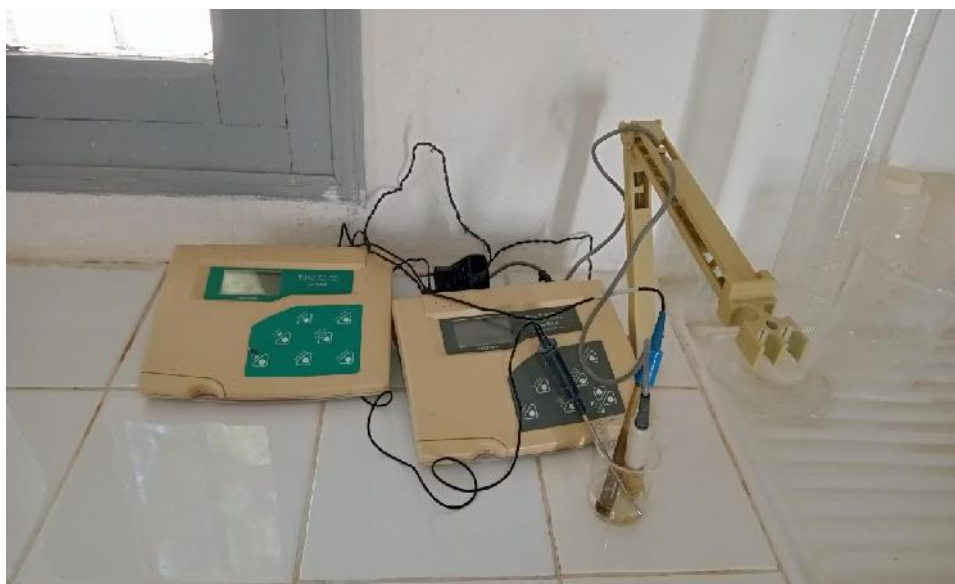
Figure 17 : pH mètre (à gauche (en vert)) et conductimètre (à droite (en gris)).
