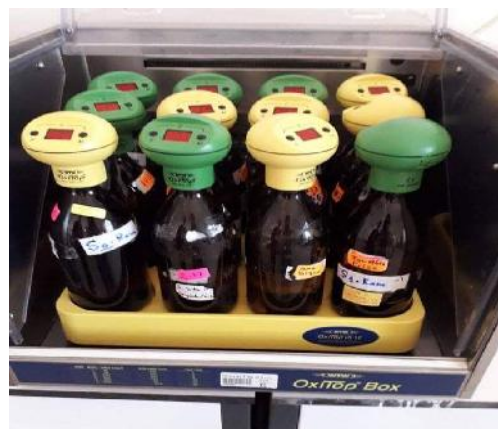
Figure 19: Dispositif de mesure de la DBO_5
