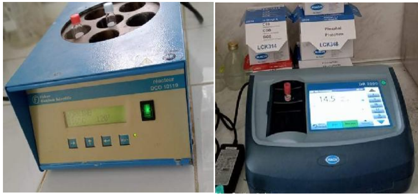
Figure 23: Réacteur utilisée pour la mesure de la DCO à gauche et un spectrophotomètre à droite
