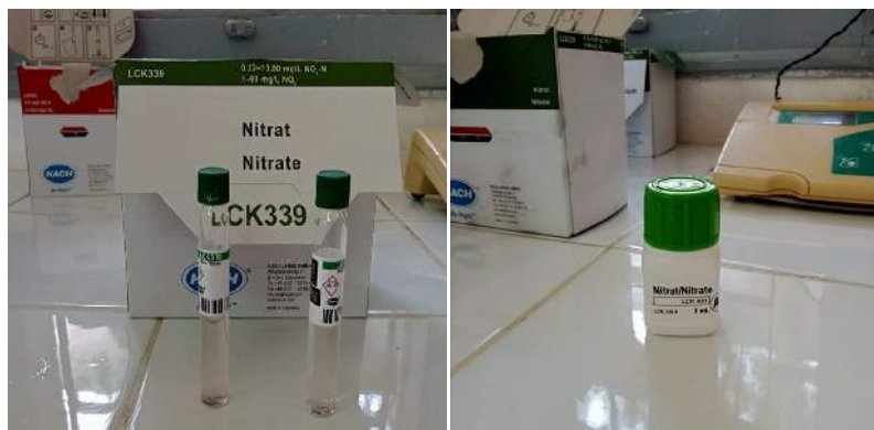
Figure 24: Photo représentant la manipulation pour la détermination de \text{NO}_3^-
