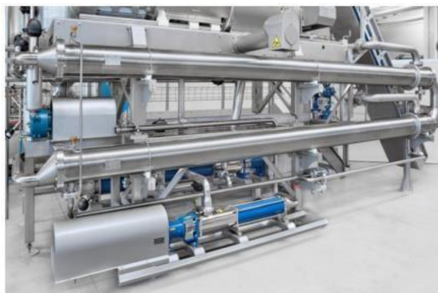
Figure II.5: Préchauffeur de la tomate.
