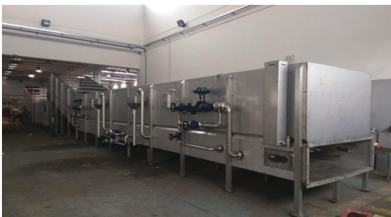
Figure II.9: Tunnel de stérilisation et de refroidissement de la purée de tomate.
