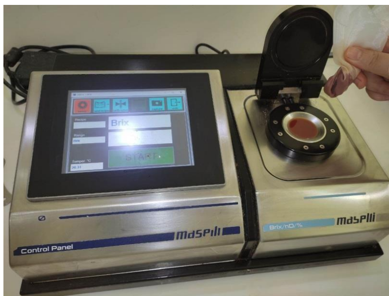
Figure IV.4: Procédé de détermination du Brix par réfractomètre.
