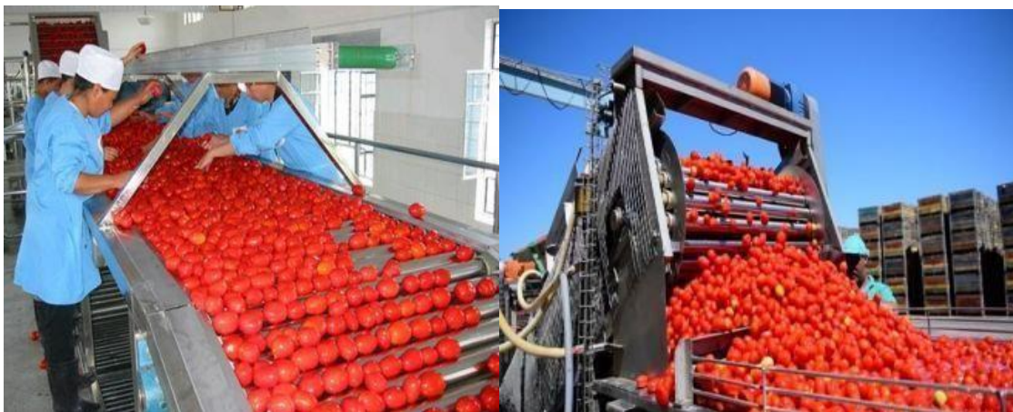
Figure II.3: Triage manuel et automatique de la tomate.
