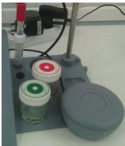
**Figure 24** : Les solutions tampon de ph=4 et ph=7
