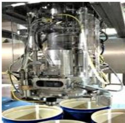
**Figure 14 :** Remplisseuse aseptique des concentrés et produits dérivés de tomate [6]
