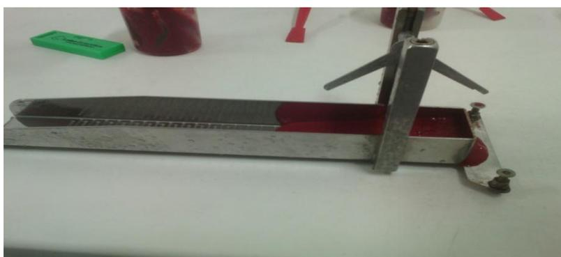
**Figure 31** : Consistomètre de Bostwick
