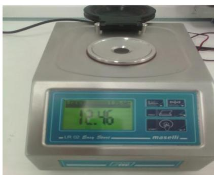
**Figure 25** : Réfractomètre Digital (L-R-02)
