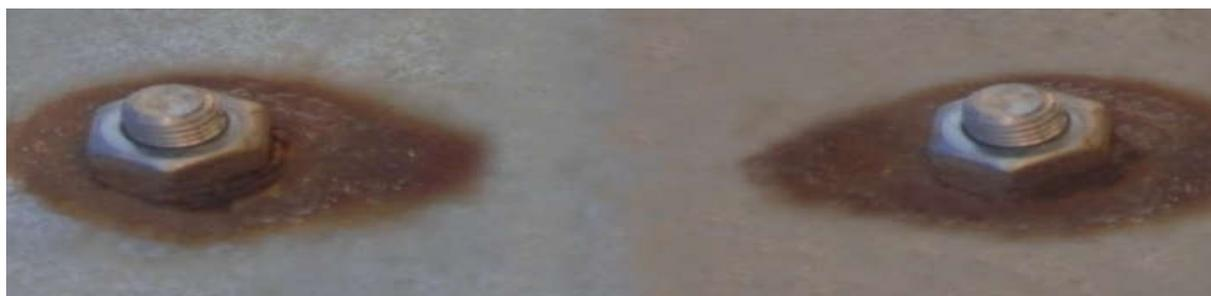
**Figure III.7 :** Effet d'une corrosion galvanique.
