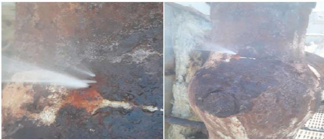
**Figure III.5 :** Effet d'une corrosion par piqûre.
