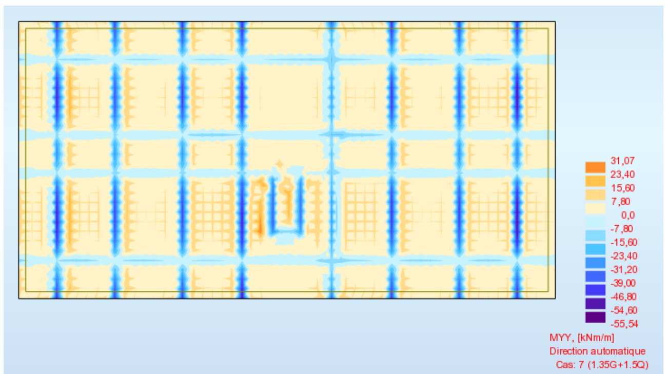
Figure (VI.8) : Différentes sollicitations agissantes au 2 ème type de radier proposé Moment :
