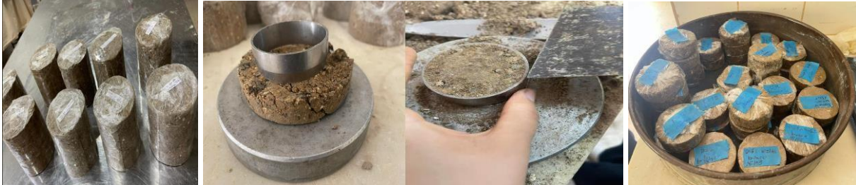
Fig. III.20 Préparation des éprouvettes pour l'essai de cisaillement rectiligne à la boîte.
