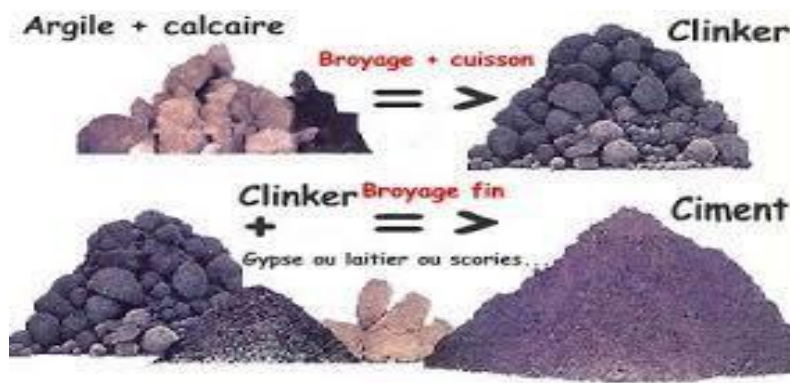
Fig. II.6 Processus de fabrication de ciment.
