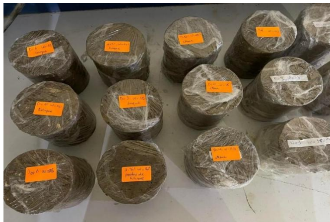
Fig. III.17 Eprouvettes aux différents pourcentages de la Chaux et de la poudre du déchet de brique rouge.
