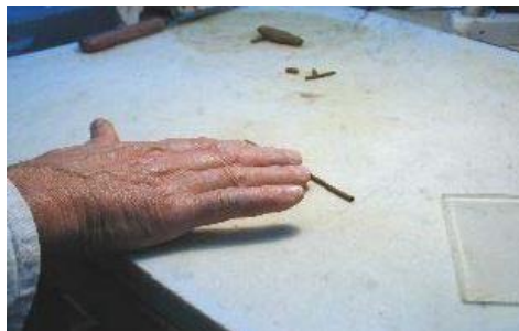
Fig. III.9 Limite de plasticité w_p par la méthode au rouleau.
