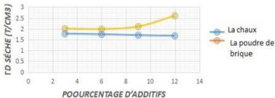
Fig. IV.10 (b) Variation de la densité sèche en fonction du pourcentage d'additifs (Chaux et PDBR).
