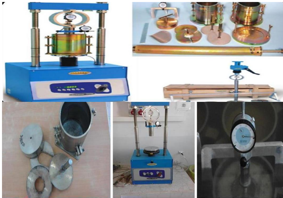
Fig. III.15 L'essai CBR (California Bearing Ratio).
