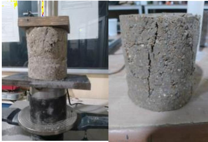
Fig. IV.14 Préparation et rupture des éprouvettes traitées sous la compression simple La résistance à la compression simple notée R_C (la contrainte maximale) est déterminée selon la formule
