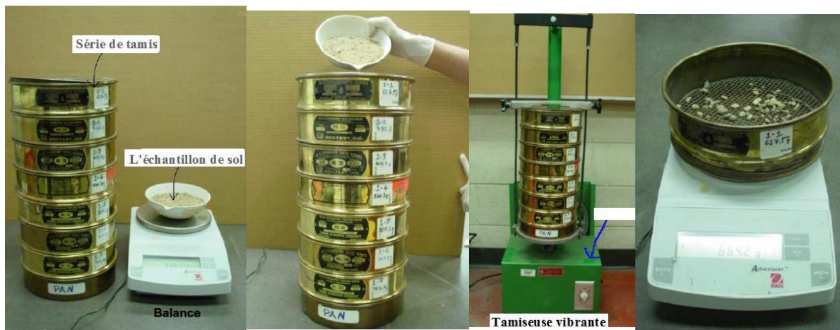
Fig. III.3 L'analyse granulométrique par tamisage.
