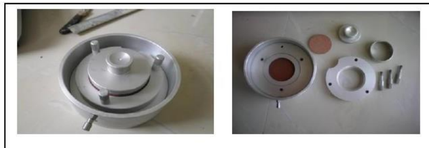
Fig. III.22 Cellule ou enceinte de consolidation.
