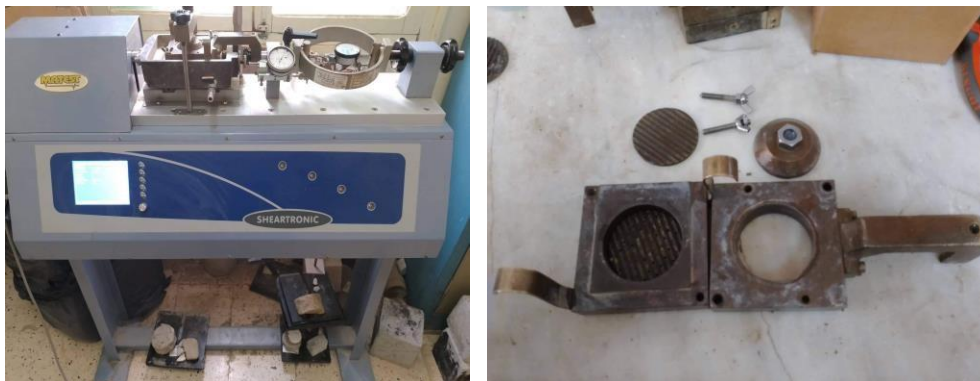
Fig. III.19 Essai de cisaillement rectiligne à la boîte avec les instruments de mesure.
