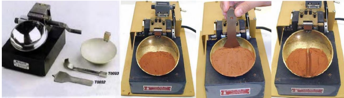
Fig. III.6 Méthode de Casagrande.
