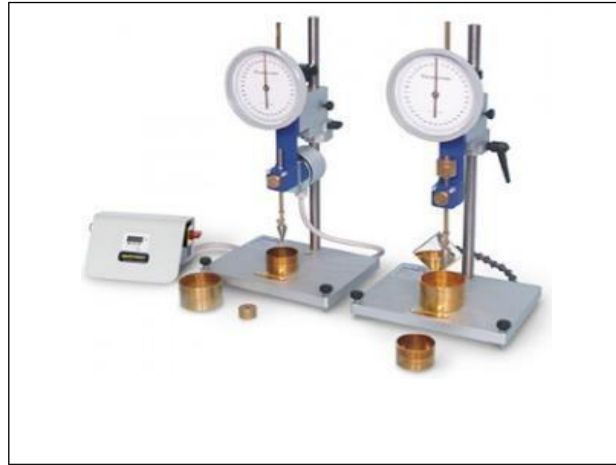
Fig. III.8 Méthode au cône de pénétration.
