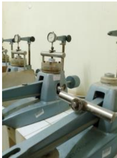
Fig. IV.28. Représentation de la machine œdométrique de laboratoire de LNHC à GUELMA.
