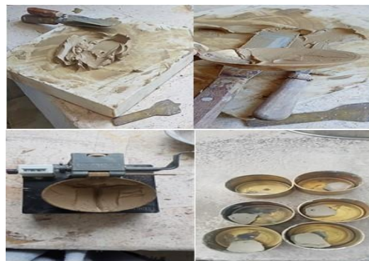
Fig. III.7 Mode opératoire pour W_l (Casagrande).
