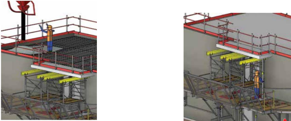
Figure 2.18 : a) Coulage du béton, b) Décoffrage et pose des étais de séchage à l'avancement [11].
