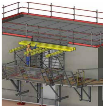
Figure 2.14 : Mise en place de l'étaie et du réseau de poutrelles primaires et secondaires [11].
