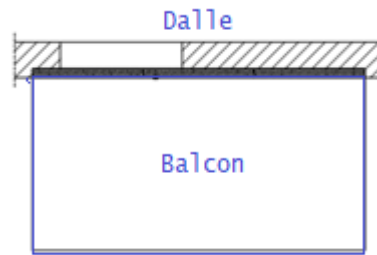
Figure 2.7 : Balcon en béton armé en porte-à-faux [10].
