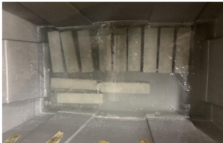
Figure II.27. Conservation des éprouvettes dans la solution d'acide sulfurique.
