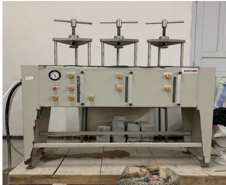
Figure II.25. Perméabilimètre à l'eau.
