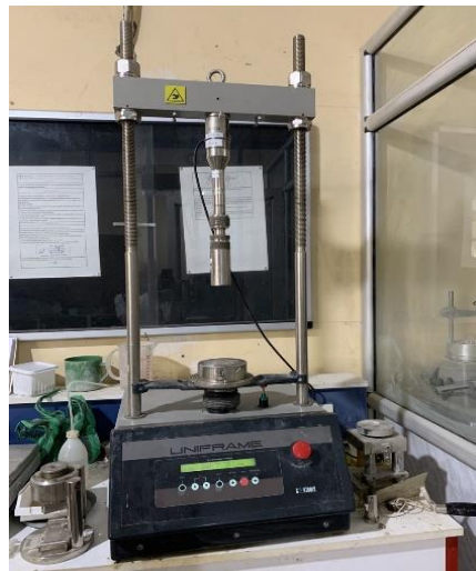
Figure II.22. Appareil pour essai de traction par flexion.
