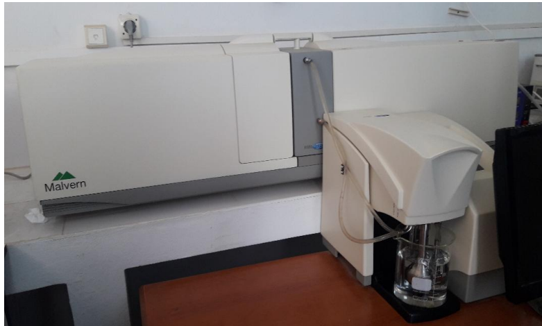
Figure II.3. Appareil granulométrie laser utilisé.
