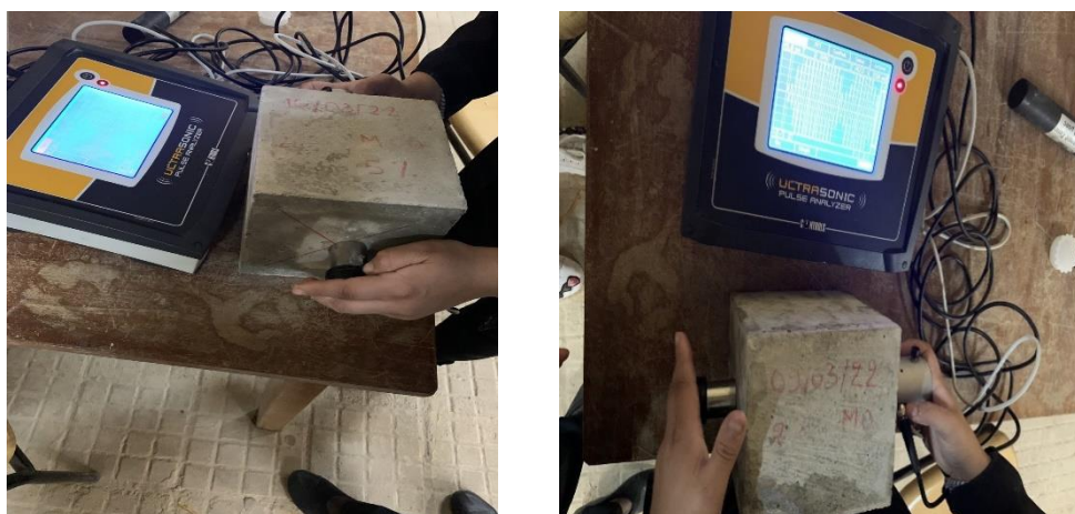
Figure III.12. Essai d'auscultation sonique
