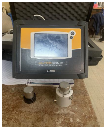
Figure II.23. Appareil d'auscultation sonique.
