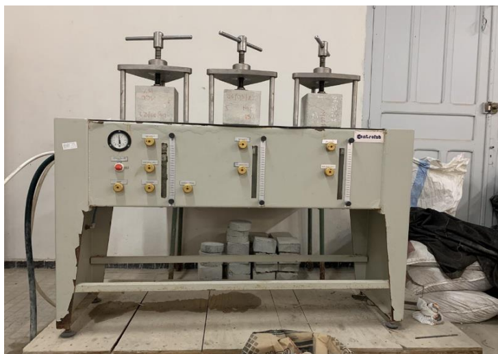
Figure III.17. Essai de perméabilité à l'eau.
