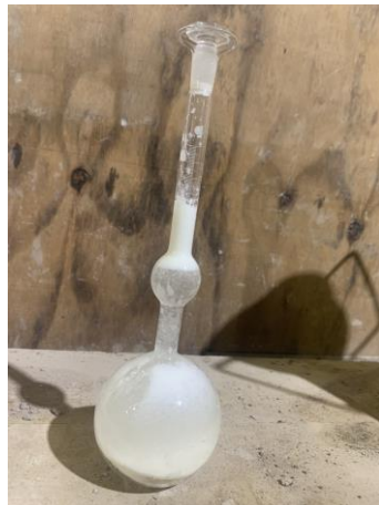
Figure II.5. Essai masse volumique absolue.
