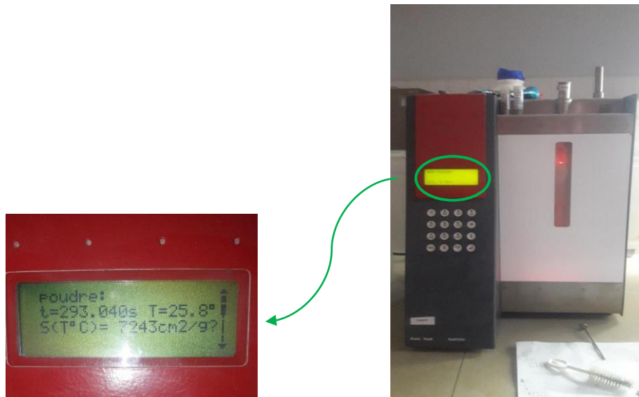
Figure II.6. Appareil de Blaine automatique.
