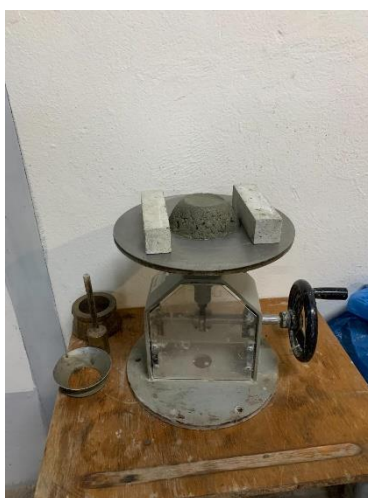
Figure III.1. Essai d'étalement pour le mortier MC5%.
