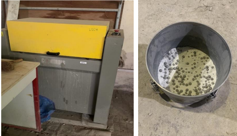
(d) Broyage des coquilles d'œufs dans le Micro-deval.
