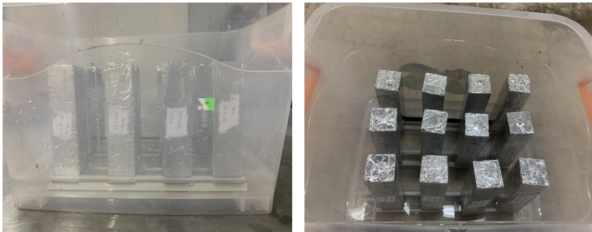
Figure III.16. Essai d'absorption d'eau par capillarité.
