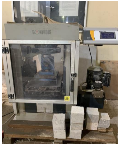
Figure II.21. Appareil d'essai de compression.
