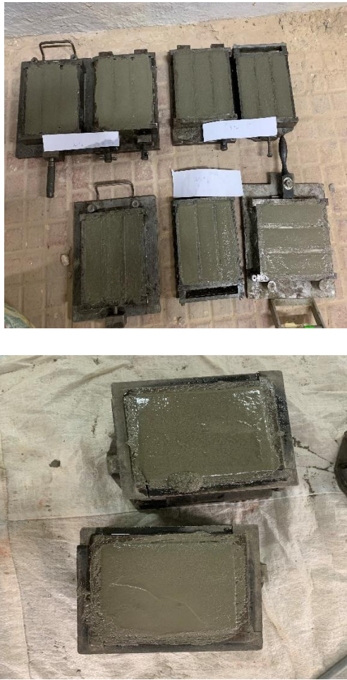
Figure II.14. Remplissage des moules.
