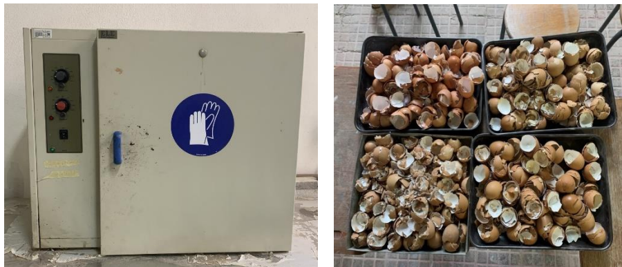
(b) Séchage des coquilles à l'étuve.
