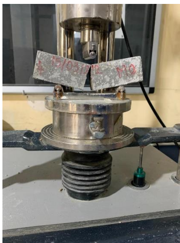
Figure III.10. Essai de traction par flexion.
