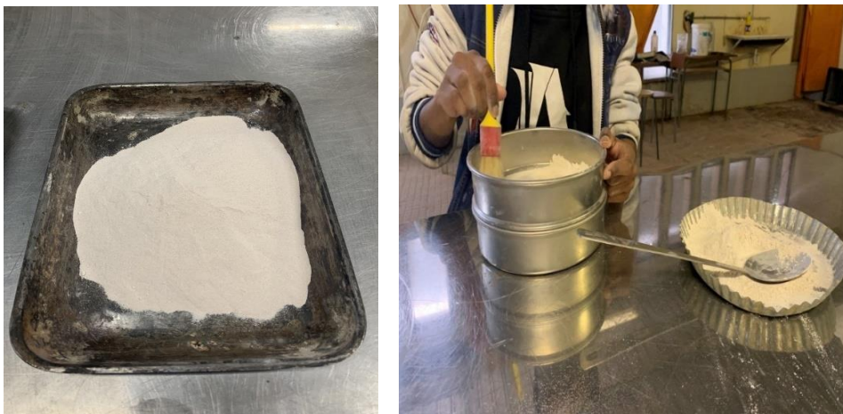
(e) Tamisage de la poudre de coquilles d'œufs sur un tamis de 63 \mu\text{m} .
