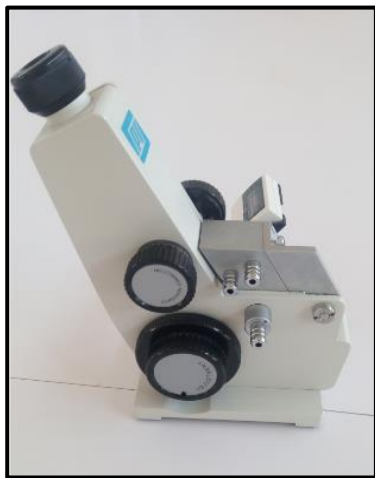
Figure 07: Réfractomètre utilisé pour la détermination de l'indice de réfraction
