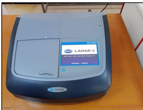
Figure 09: Spectroscopie UV-visible de type LANGE DR 6000 utilisé pour l'analyse de l'HE.
