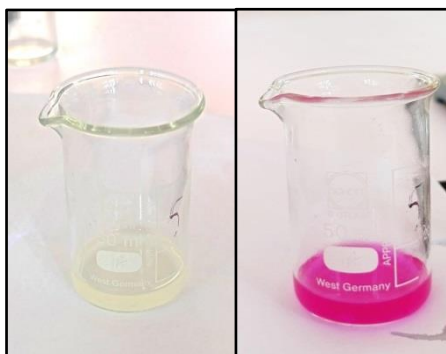
Figure 06: Solution avant le titrage (à gauche), et après titrage (à droite).
