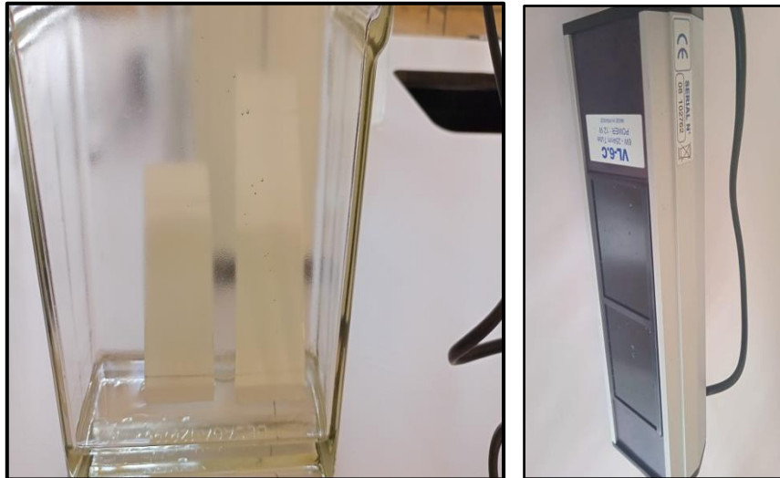
Figure 05 : Cuve de CCM (à gauche) et lampe UV utilisée pour la révélation (à droite).
