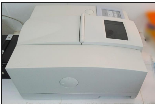
Figure 10: Spectrophotomètre à IRTF utilisé pour l'analyse
