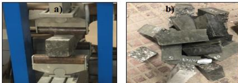
Figure II.23 : Procédure d'essai de traction par flexion.
