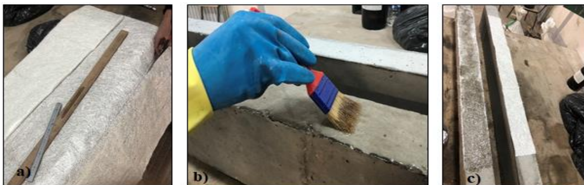
Figure II.35 : Collage de matériau composite.
