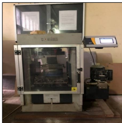
Figure II.20 : Presse hydraulique de l'essai de compression.
