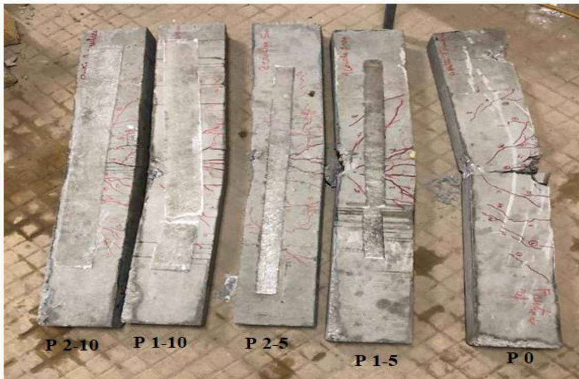
Figure III.12 : Mode de rupture des composites de l'ensemble de poutres
