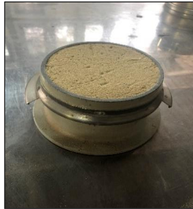
Figure II.3 : Masse volumique apparente du sable.
