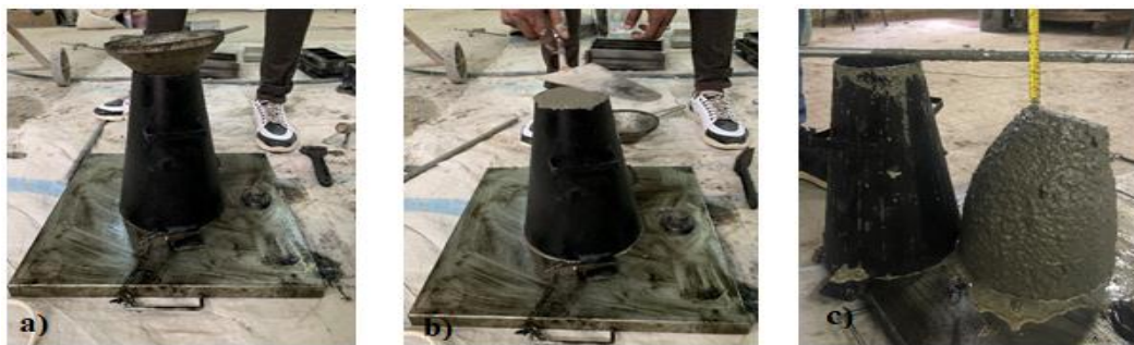
Figure II.14 : Essai d'affaissement au cône d'Abrams.
