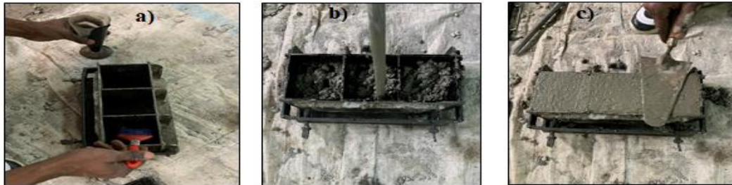
Figure II.16 : Confection des éprouvettes cubiques.
