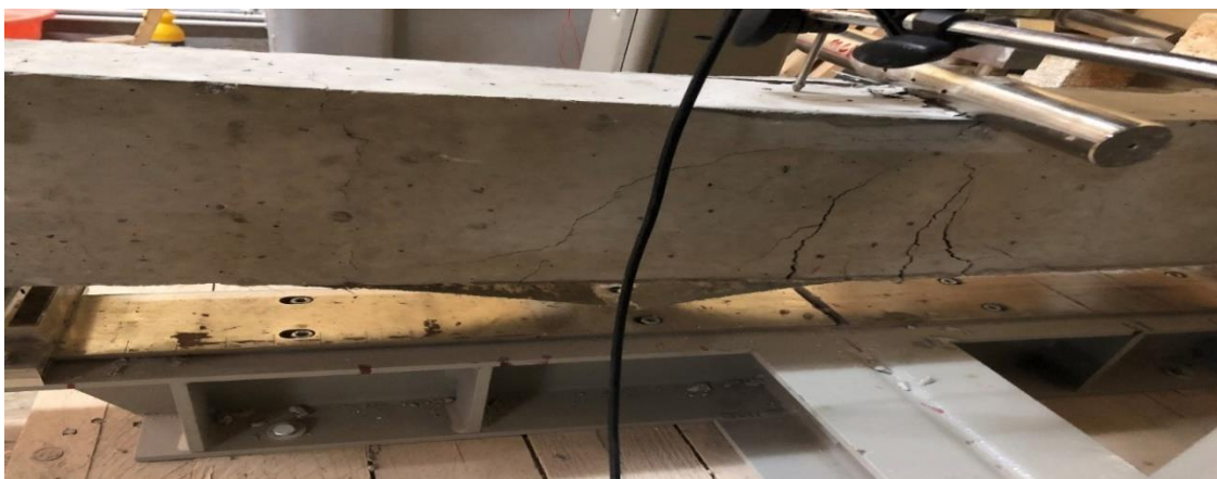
Figure III.7 : Rupture de la poutre renforcée (P1-5).
