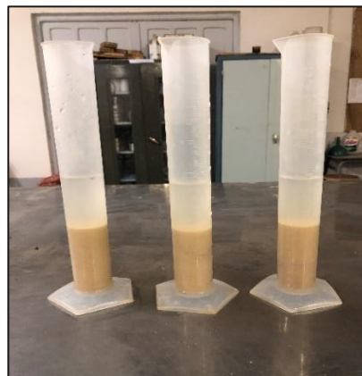
Figure II.2 : Masse volumique absolue du sable.
