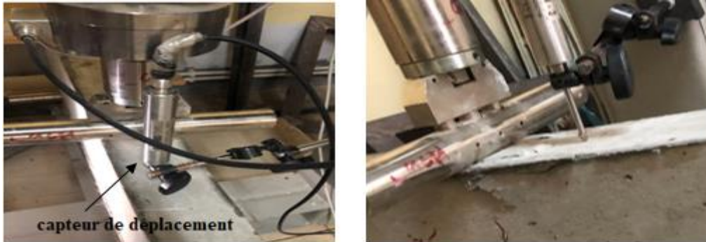
Figure II.38 : Mise en place du capteur de déplacement.
