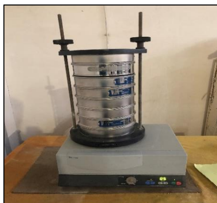
Figure II.5 : Série de tamis et tamiseuse électrique.
