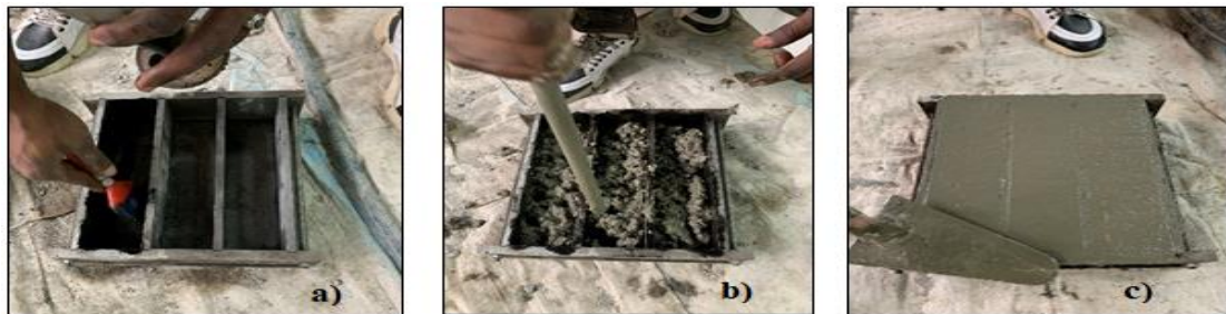
Figure II.18 : Confection des éprouvettes prismatiques.
