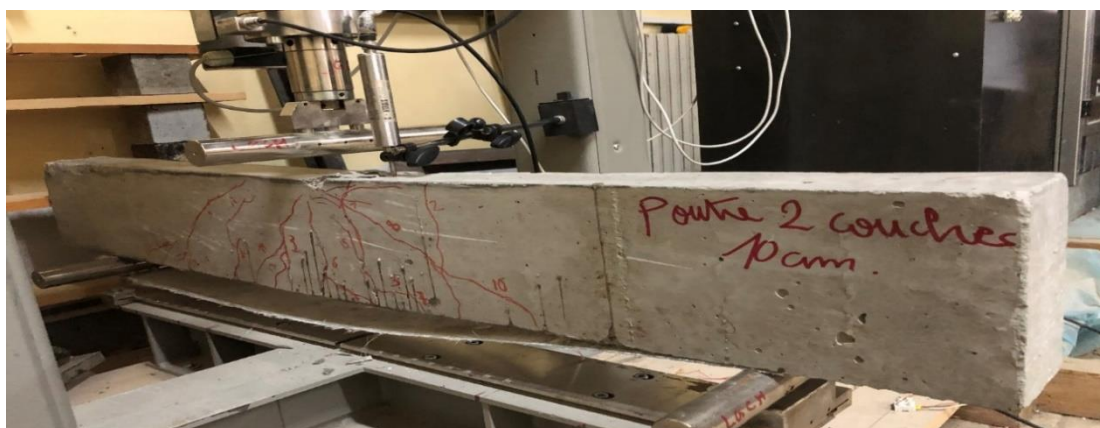
Figure III.10 : Rupture de la poutre renforcée (P2-10).
