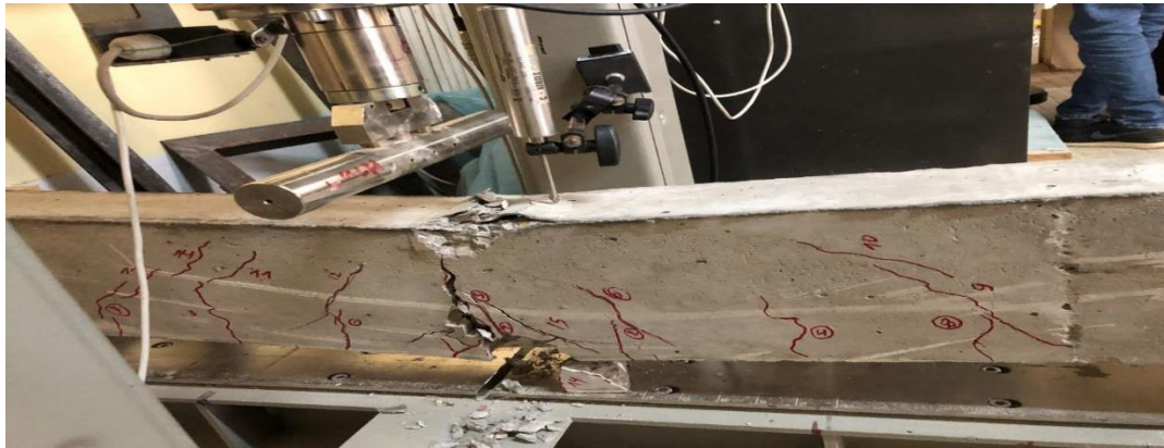
Figure III.6 : Rupture due au moment fléchissant de la poutre de référence (P0)
