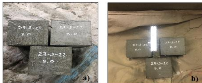
Figure II.17 : Décoffrage et conservation des éprouvettes cubiques.
