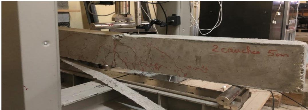
Figure III.9 : Rupture de la poutre renforcée (P2-5).
