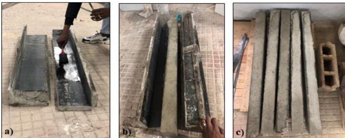
Figure II.29 : Procédure de fabrication des poutres.
