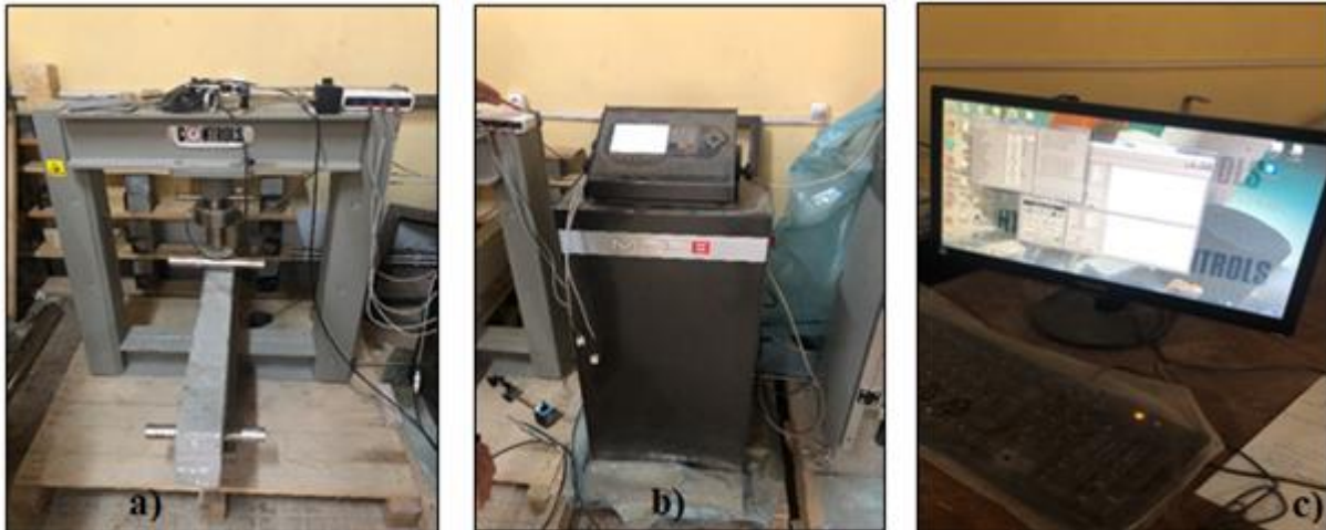
Figure II.32 : Machine d'essai de flexion trois points.
