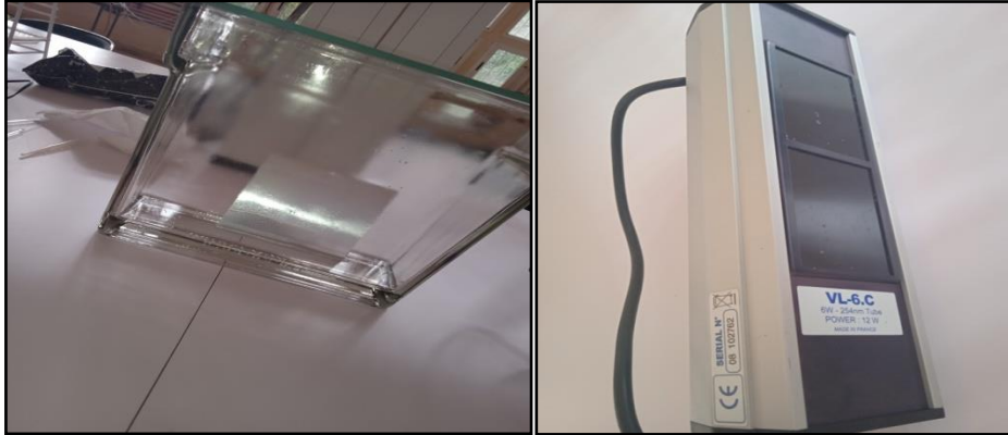
Figure 05 : Cuve chromatographique (à gauche) et lampe à UV (à droite) utilisées pour le test de la CCM
