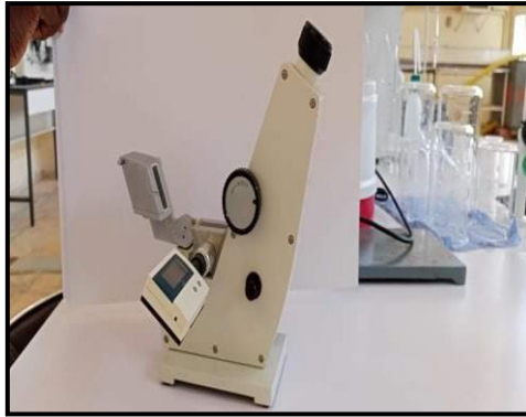
Figure 09 : Le refractomètre utilisé pour la détermination de l'indice de réfraction de l'HE
