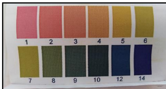
Figure 10 : Papier pH montrant la gamme de couleur selon le pH de la solution analysée
