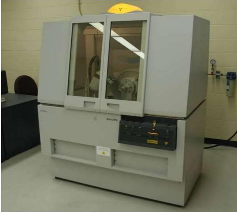
**Figure 4.10** : Diffractomètre de Rayons X modèle Phillips Xpert-pro ([ARUSM-ITRC](#)).
