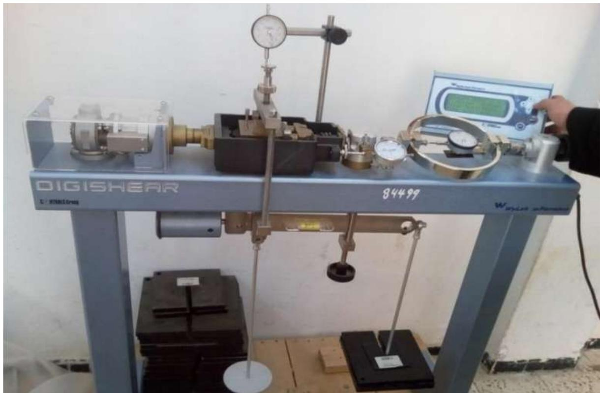
**Figure 4.22** : Boite de cisaillement direct .
