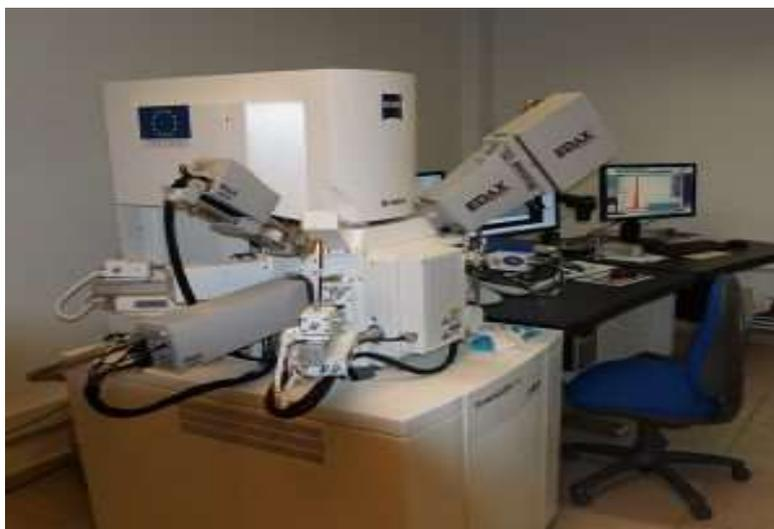
**Figure 4.15** : Photographie de l'appareil MEB équipé d'un détecteur EDS (ARUSM-ITRC).
