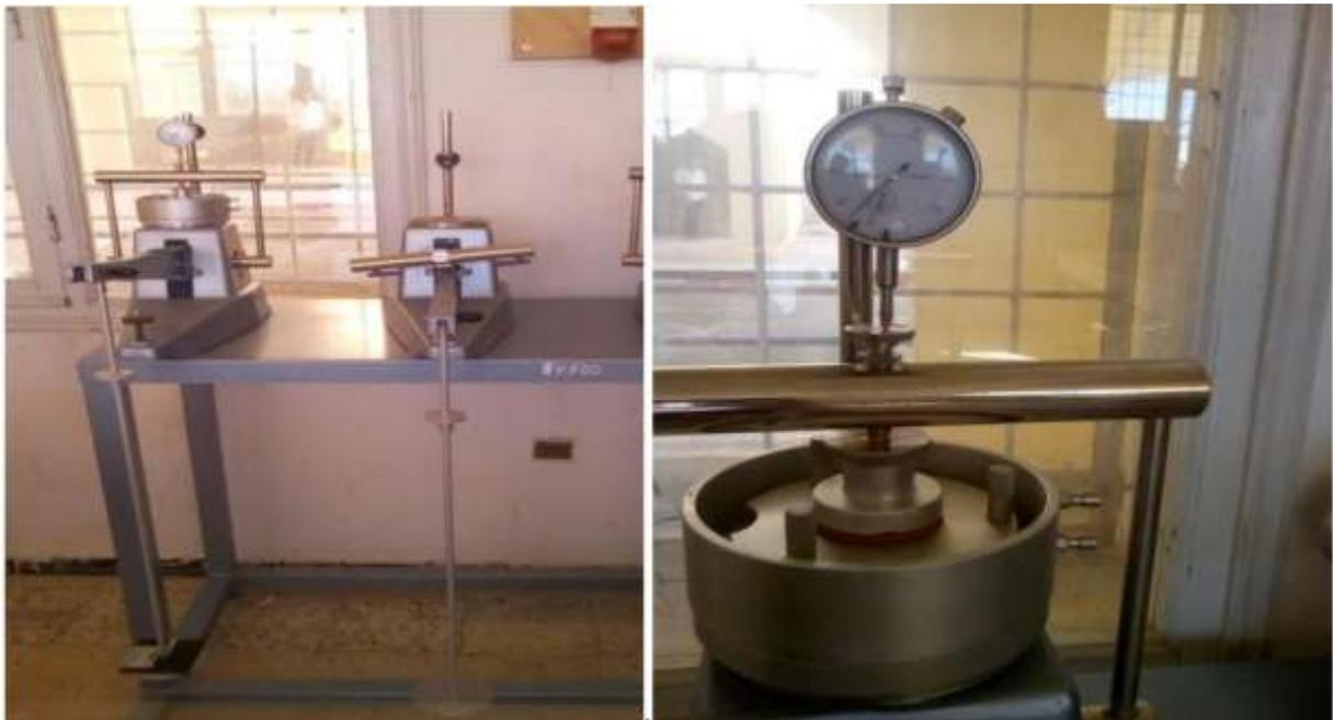
**Figure 4.20** : cellule oedométrique pour l'essai de consolidation uniaxiale.
