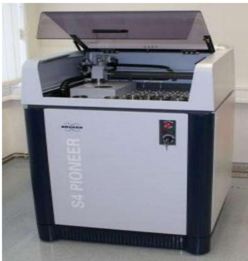
**Figure 4.12** : Analyseur fluorescence X (S4 Pioneer) ([ARUSM-ITRC](#)).
