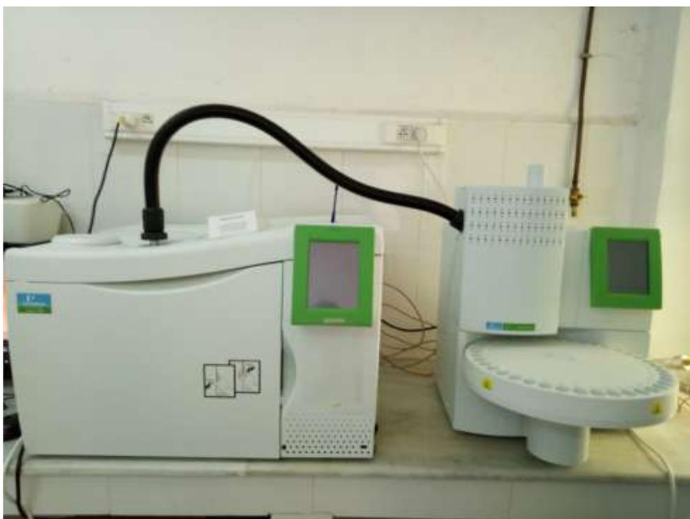
**Figure 4.17** : Chromatographe couplé à un détecteur à ionisation de flamme (GC-FID )
