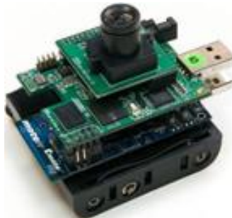
Figure I. 11 Un nœud de capteur Cyclops avec une carte Mica z interfacée[56].
