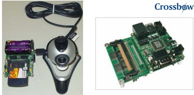
Figure I. 10 Un nœud capteur vidéo avec la plateforme Stargate de Cross Bow avec une carte MICAz interfacée avec une Webcam[55].
