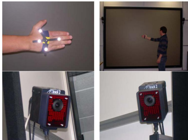
Figure 2.15 : Marqueurs sphériques rétro-réfléchissants placés sur la main du sujet pour en récupérer la trajectoire et caméras infrarouges optiques ARTrack2 utilisées pour la capture de mouvement.
