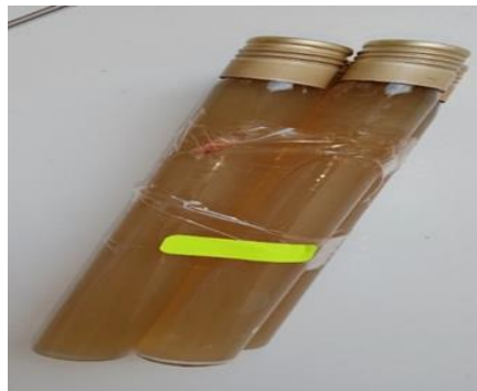
Figure 24: la recherche des clostridies sulfito-réductrices.
