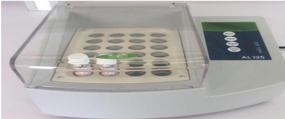
**Figure 14:** Réacteur pour mesurer la DCO (prise personnelle).
