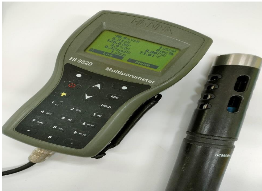
Figure 10 : Multi-paramètre de type Hanna-Instruments (HI 9829) (Photo personnelle, 2021).
