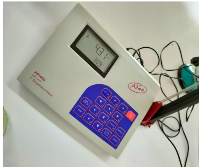
Figure 9 : pH mètre de type AD1030 (Photo personnelle, 2021).
