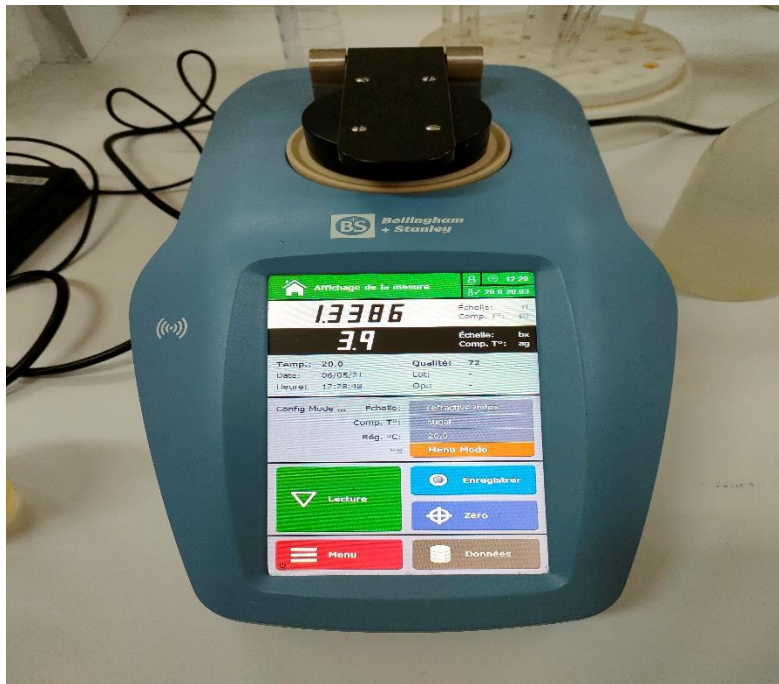
Figure 8 : Réfractomètre de type Bellingham et Stanley (Photo personnelle, 2021).
