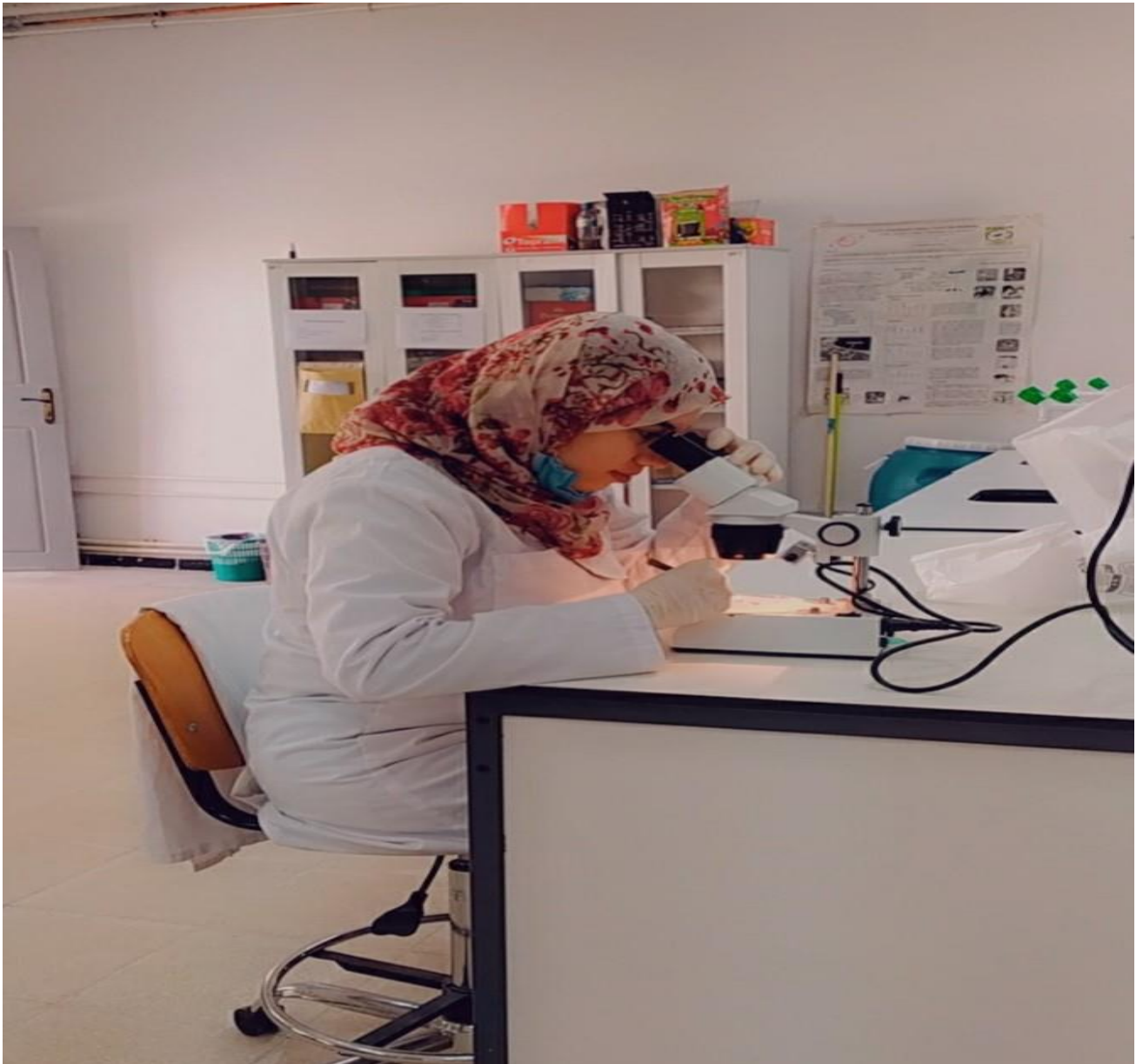
Figure 14 : Séparation des particules à l'aide d'une binoculaire (photo original)
