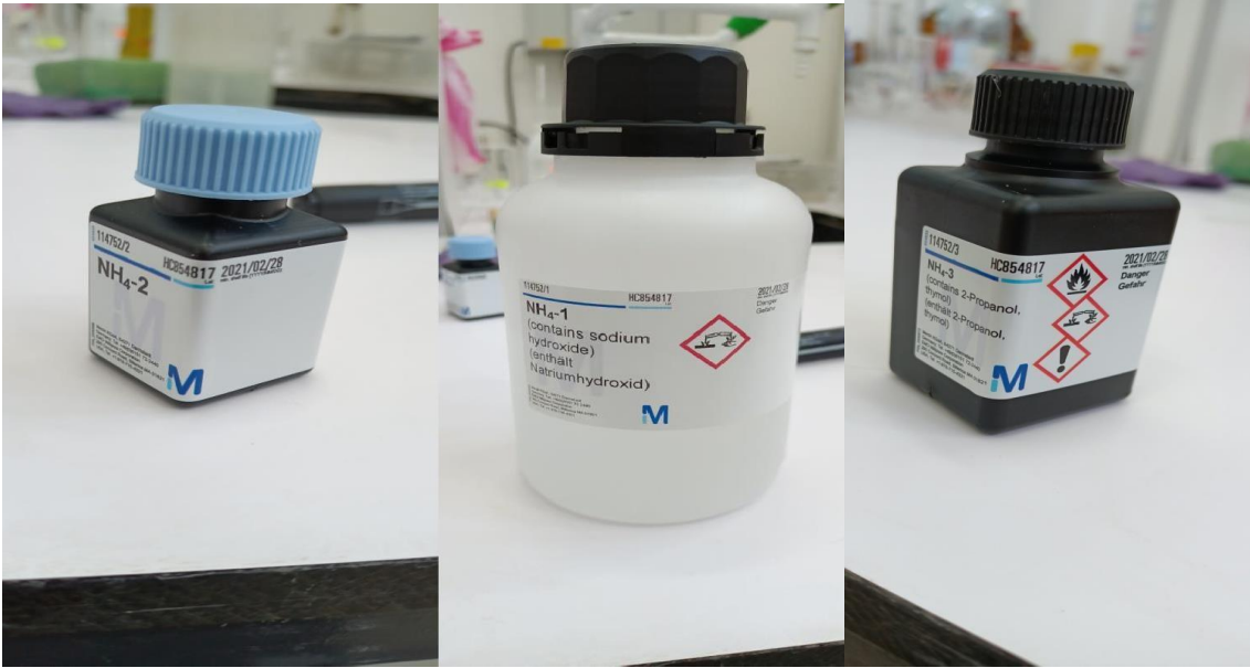
Figure 28 : Photos des réactifs (NH4-1, NH4-2 et NH4-3) pour le dosage d'Ammonium
