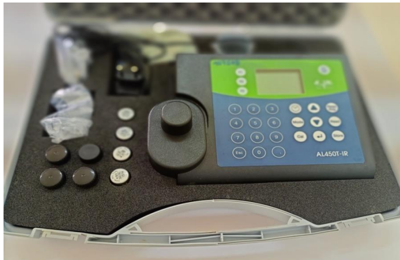
Figure 11: Représente un turbidimètre paillasse de type AQUALYTIQUE (AL450T-IR)
