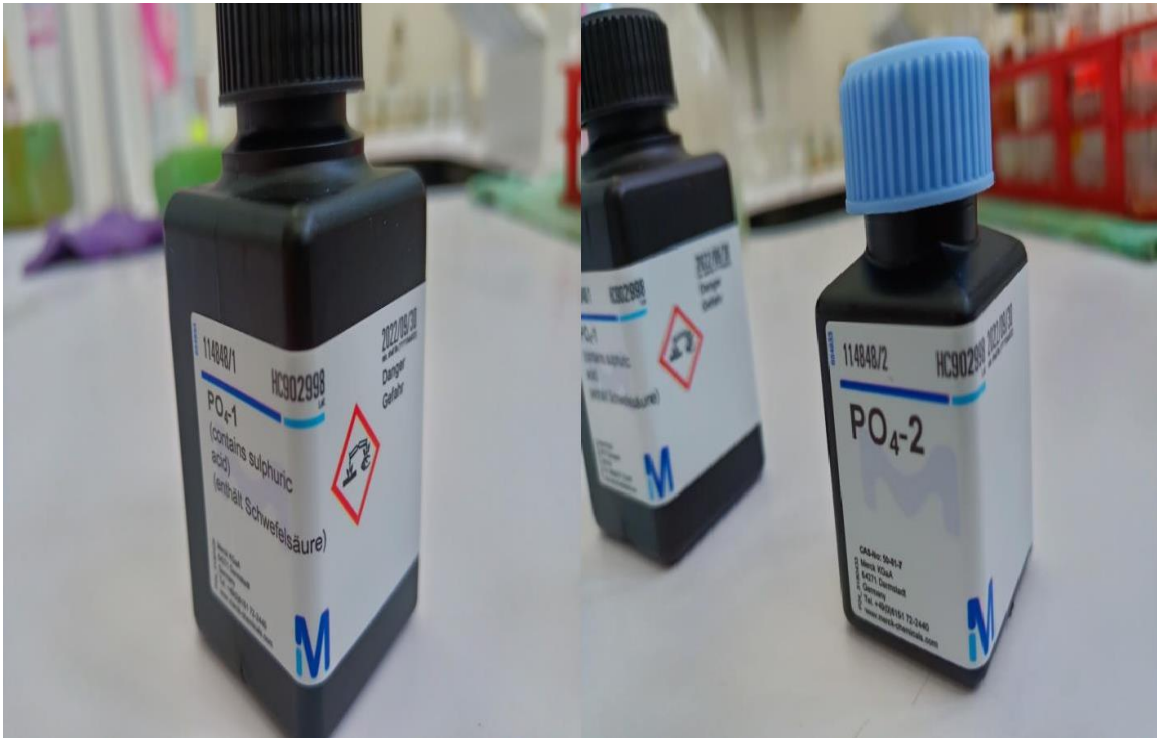
Figure 27 : Photos des réactifs ( PO4-1, PO4-2) pour le dosage d'ortho-phosphate
