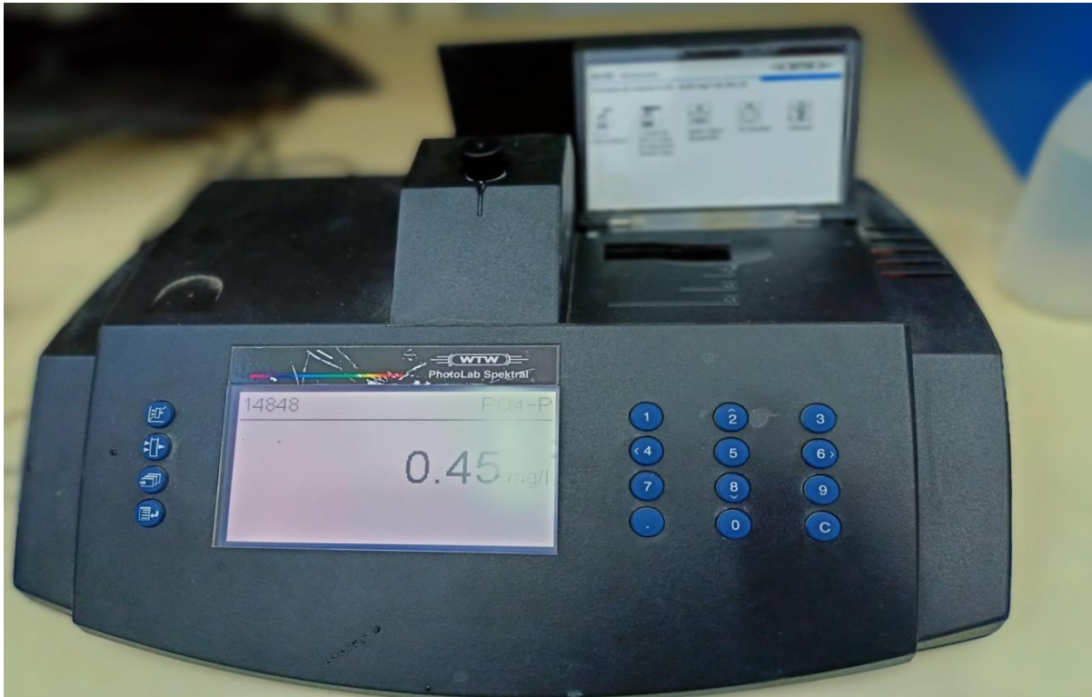
Figure 12: photo d'un spectrophotomètre de type WTW PhotoLab Spektral.
