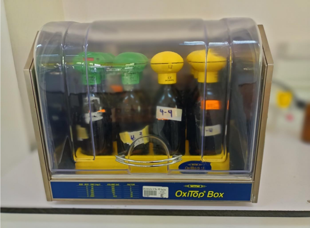
Figure 13: Photo d'un DBO mètre de type WTW OxiTop Box
