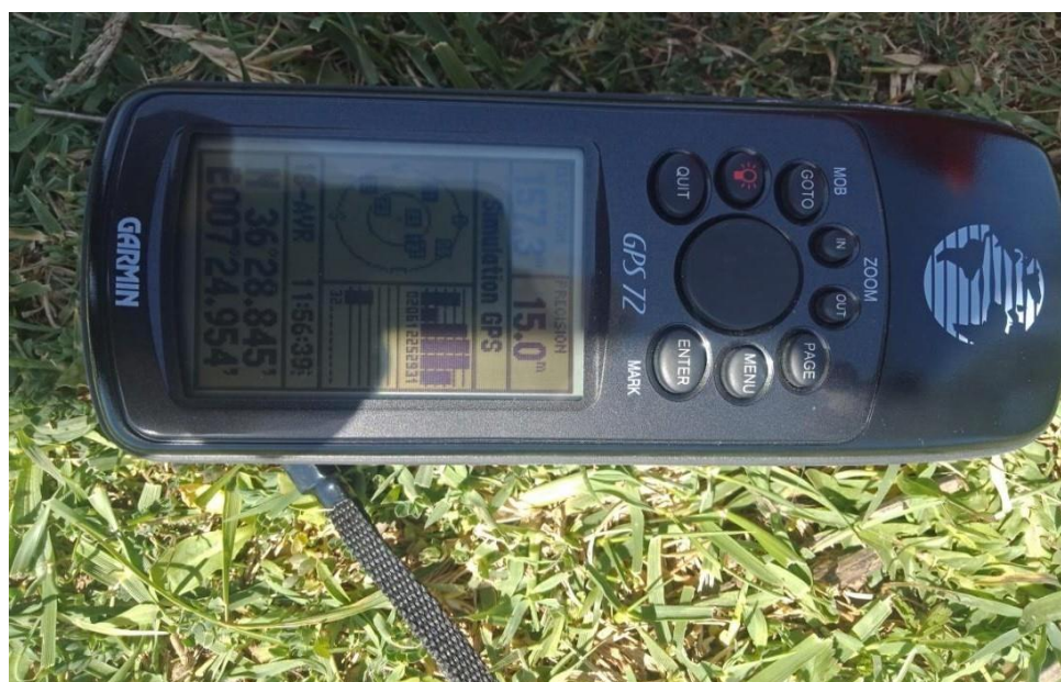
Figure 9: Photo d'un GPS de type 72 GARMIN.
