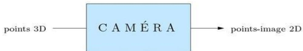
**Figure 1.2 :** Calibrer une caméra consiste à estimer sa fonction de transfert
