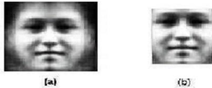
Figure 1.14 : a) Pattern de visage avec égalisation d'histogramme. b) Pattern de visage après élimination du fond.[7]
