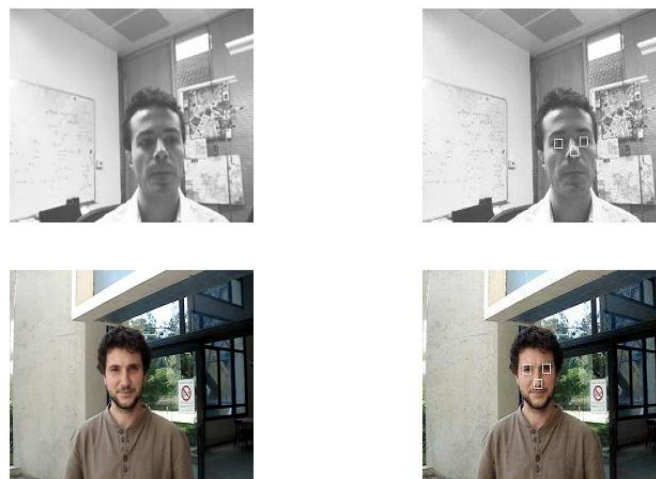
Figure 1.16 : Exemple de détection des points d'intérêt. De gauche à droite : première image de la séquence ; les zones d'intérêt, yeux et nez, détectées de manière automatique.
