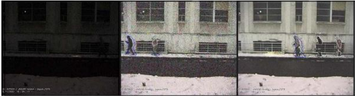
Figure 1.9 : De gauche à droite : l'image brute, l'image rendue plus lisible, et en fin avec l'amélioration de netteté du fond[5]
