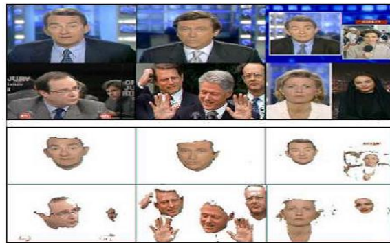
Figure 1.13 : Détection de la couleur de la peau dans diverses images.[1]
