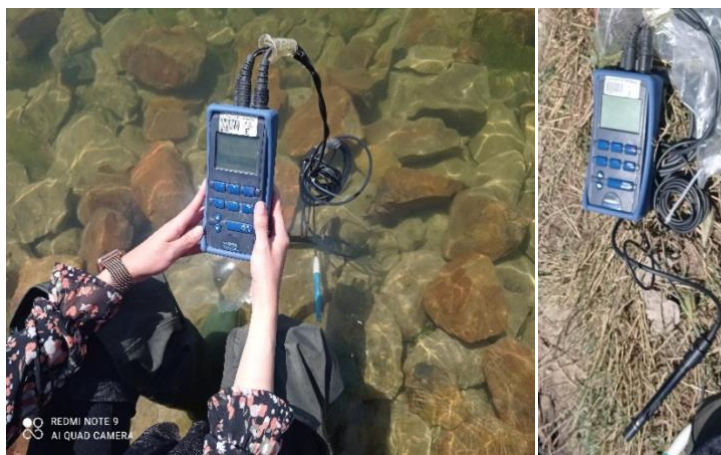
Figure 15: Photos de multi paramètre utilisé (WTW Multi 350i) (Photos prise personnel en situ de prélèvement)
