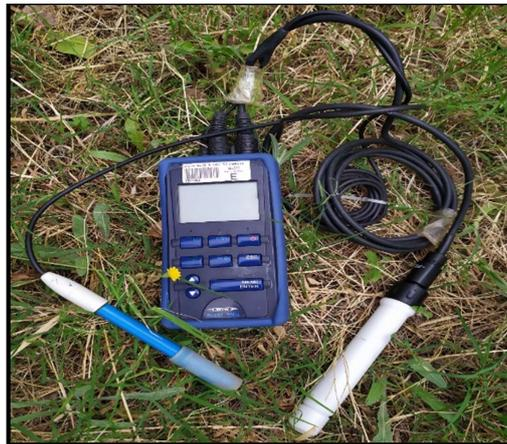
**Figure 11 : Multi-paramètre WTW multi350i (photo prise par MAIZI, 2021).**
