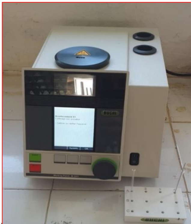
Figure 5.4 : Point de fusion M-560 BUCHI (Appareil utilisé pour la mesure du point de fusion).
