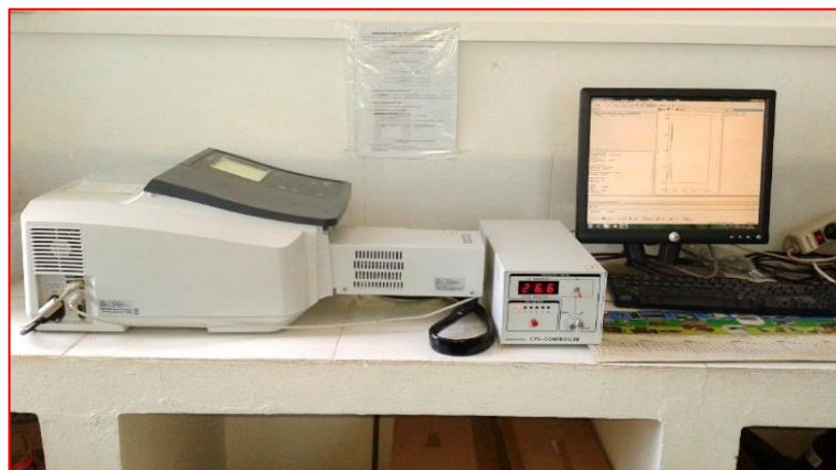
Figure 5.11 : Spectrophotomètre UV-Visible à double faisceau Shimadzu model UV 1800.
