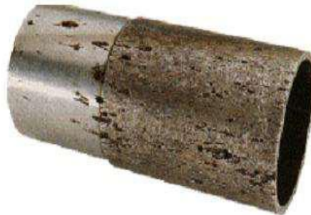
Figure II -4 : Corrosion par piqûre.
