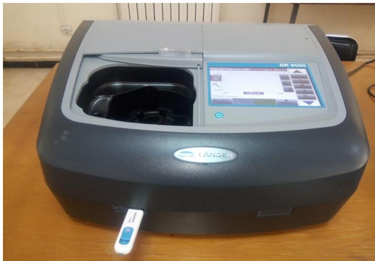
Figure III.4: Spectrophotomètre UV-Visible de type LANGE DR 6000.
