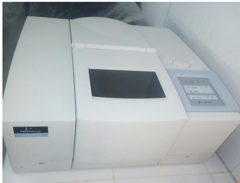
Figure III.5: Spectromètre à transformée de Fourier (IR-TF) marque Perkin Elmer Spectrum one.
