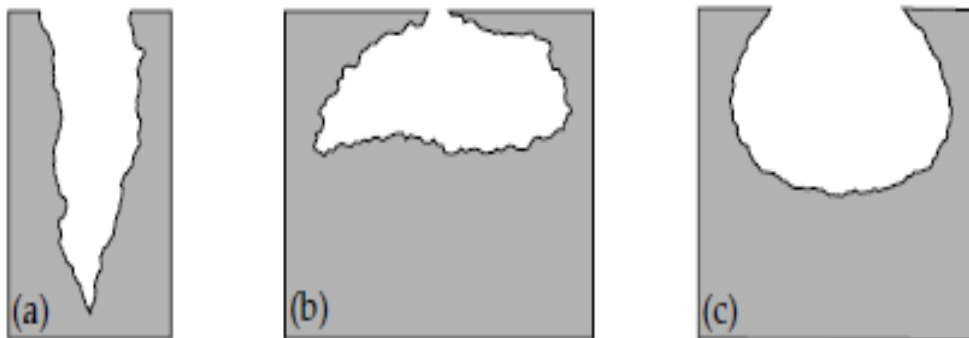
Figure I.5: Formes de piqûres (a) cavité profonde (b) cavité cavernieuse (c) hémisphérique [2].
